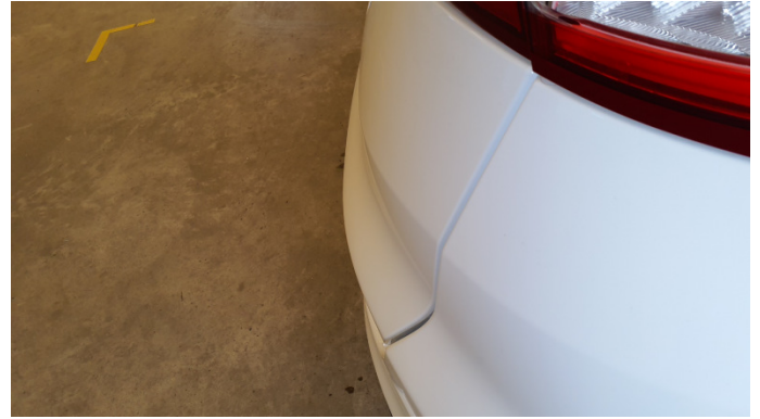
14. Heckklappe Spaltmaß Ungenau -
