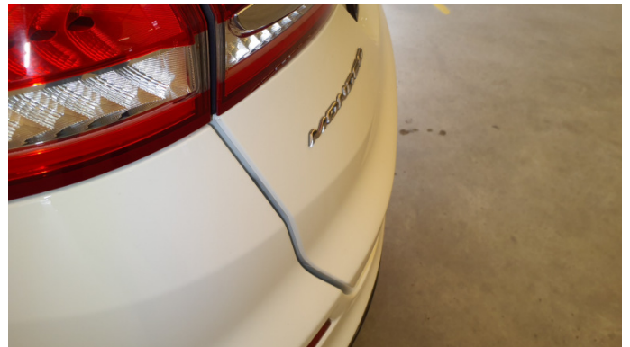
14. Heckklappe Spaltmaß Ungenau -
