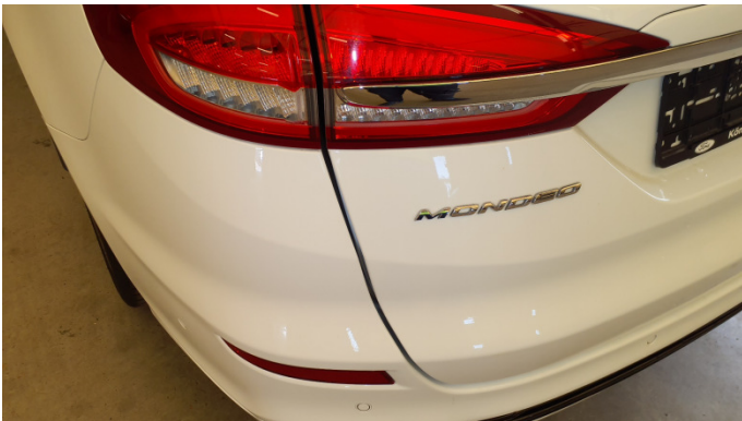
14. Heckklappe Spaltmaß Ungenau -
