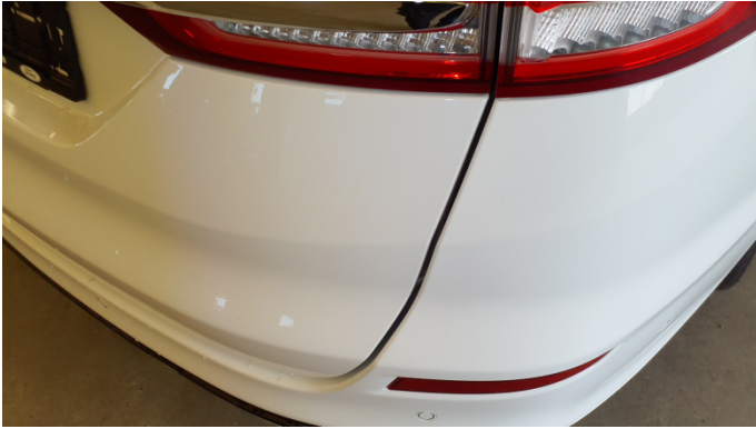
14. Heckklappe Spaltmaß Ungenau -
