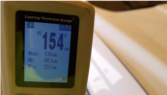
7. Kotflügel Vorne - Rechts Nachlackiert -
