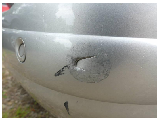
Bild 11: Karosserie / Stoßfänger hinten gebrochen
