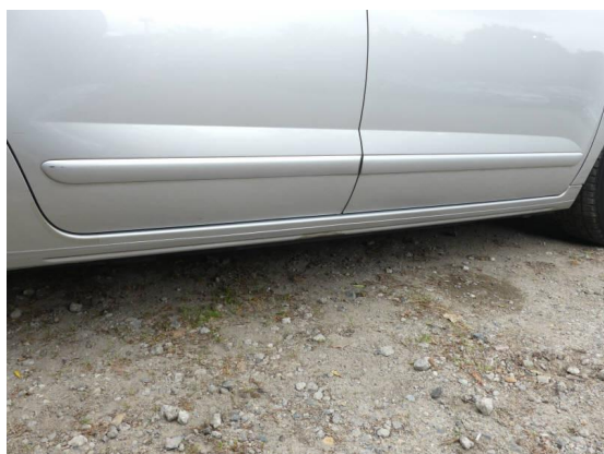
Bild 3: Karosserie / Schweller mittig rechts beschädigt
