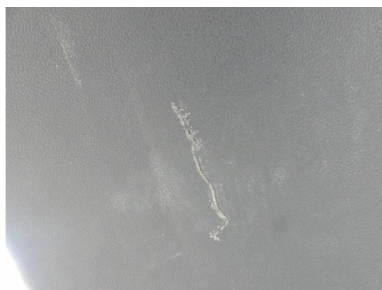
Bild 18: Innenraum / Heckklappenverkleidung Kratzer
