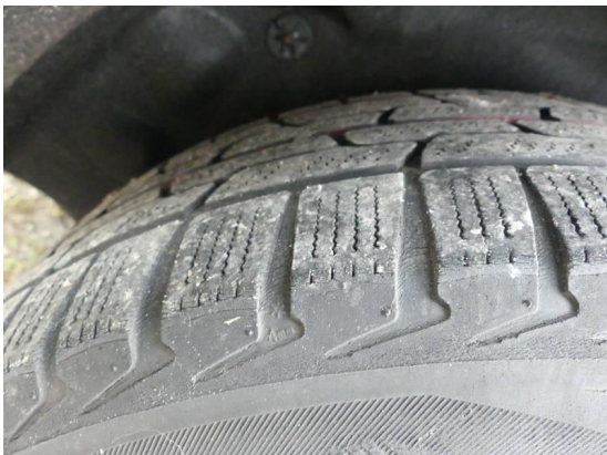
Bild 47: Reifen - Felge / Winterreifen rissig/porös kurz vor Verschleißgrenze
