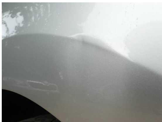
Bild 7: Karosserie / Kotflügel hinten rechts deformiert
