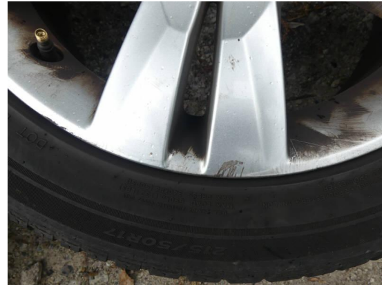
Bild 50: Reifen - Felge / Alufelgen 2.Radsatz Kratzer
