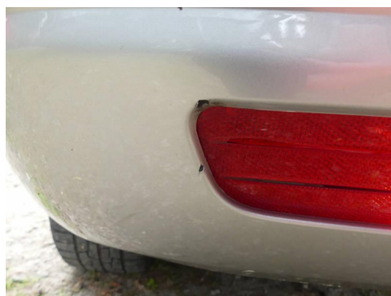
Bild 12: Karosserie / Stoßfänger hinten gebrochen
