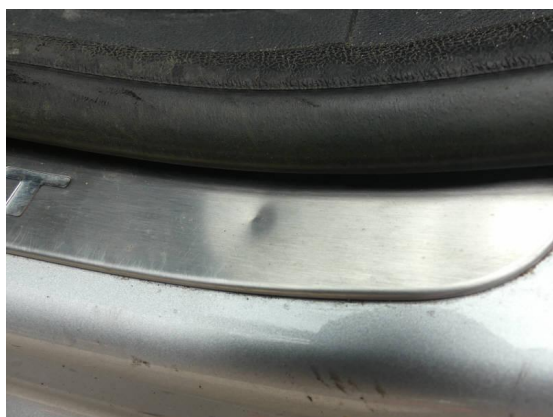
Bild 27: Karosserie / Zierleiste Einstieg vorne links Delle
