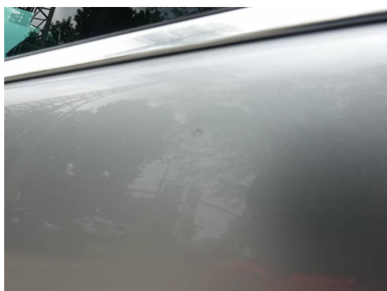
Bild 29: Karosserie / Tür hinten links Dellen
