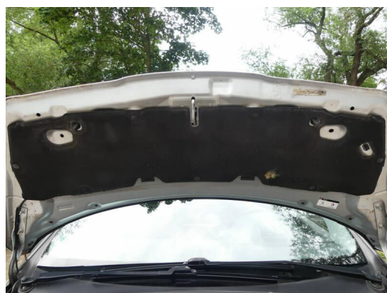
Bild 24: Karosserie / Dämmmatte Motorraum gerissen
