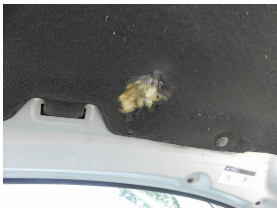
Bild 25: Karosserie / Dämmmatte Motorraum gerissen
