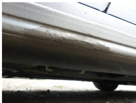
Bild 4: Karosserie / Schweller mittig rechts beschädigt
