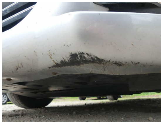
Bild 32: Karosserie / Stoßfänger vorne Kratzer
