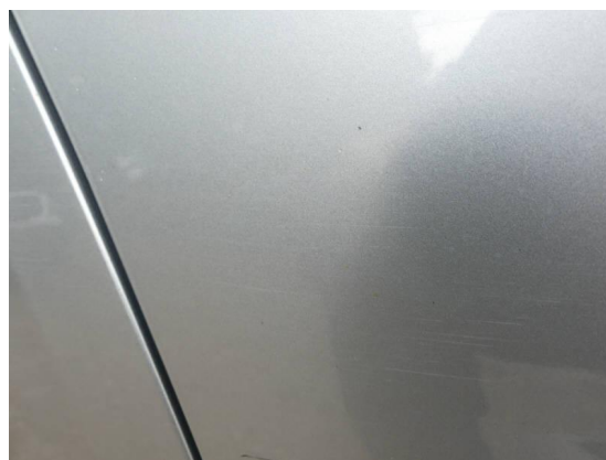
Bild 40: Karosserie / Tür hinten rechts Kratzer
