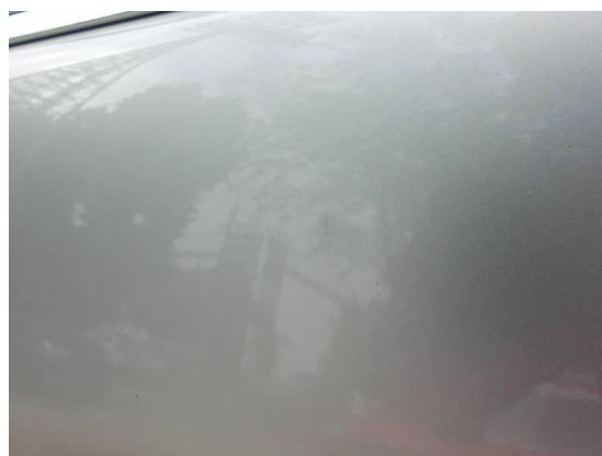
Bild 30: Karosserie / Tür hinten links Dellen
