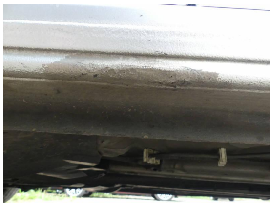
Bild 5: Karosserie / Schweller mittig rechts beschädigt
