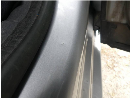
Bild 43: Karosserie / Einstieg hinten rechts Delle und Kratzer
