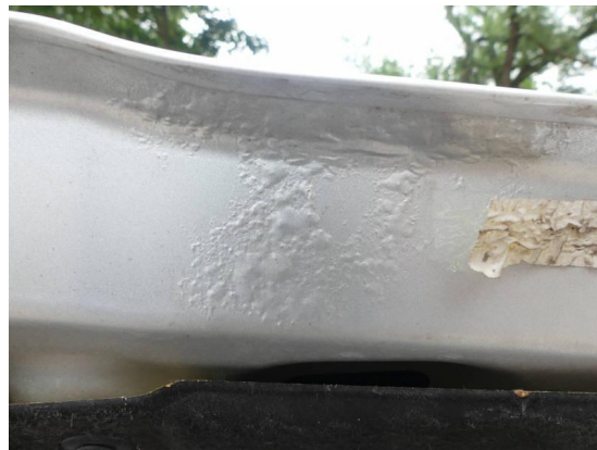
Bild 2: Karosserie / Motorhaube Korrosion
