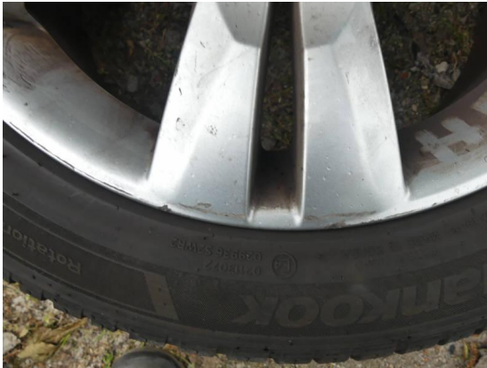
Bild 49: Reifen - Felge / Alufelgen 2.Radsatz Kratzer
