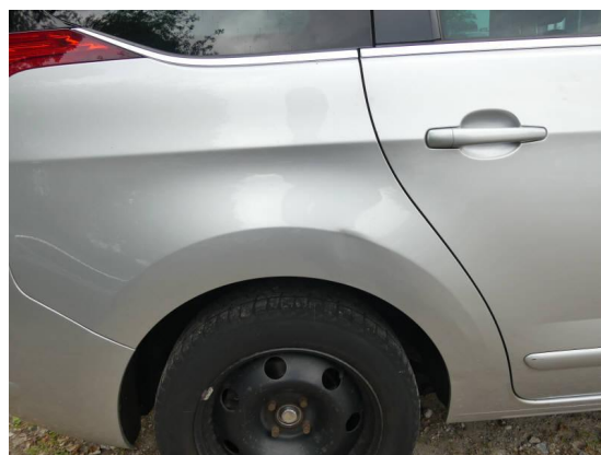
Bild 6: Karosserie / Kotflügel hinten rechts deformiert
