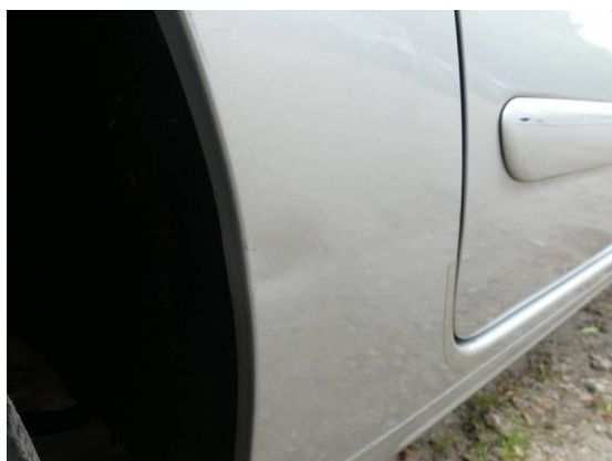
Bild 9: Karosserie / Kotflügel hinten rechts deformiert
