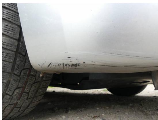
Bild 34: Karosserie / Stoßfänger vorne Kratzer
