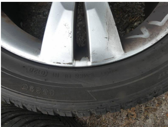
Bild 51: Reifen - Felge / Alufelgen 2.Radsatz Kratzer
