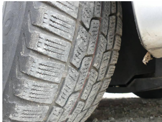
Bild 46: Reifen - Felge / Winterreifen rissig/porös kurz vor Verschleißgrenze
