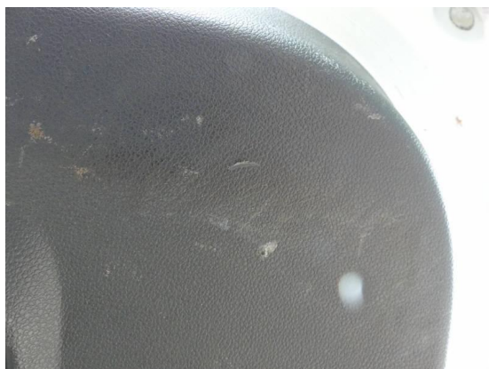
Bild 19: Innenraum / Heckklappenverkleidung Kratzer
