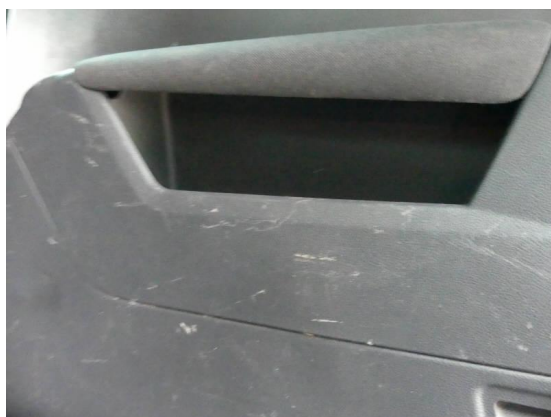
Bild 21: Innenraum / Kofferraumverkleidung Kratzer
