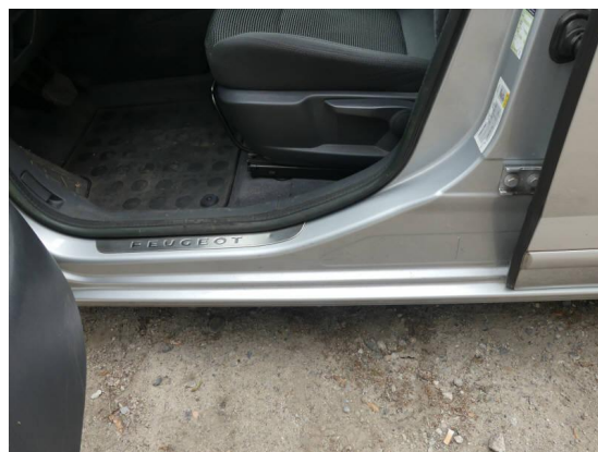
Bild 26: Karosserie / Zierleiste Einstieg vorne links Delle
