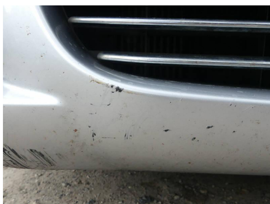
Bild 33: Karosserie / Stoßfänger vorne Kratzer
