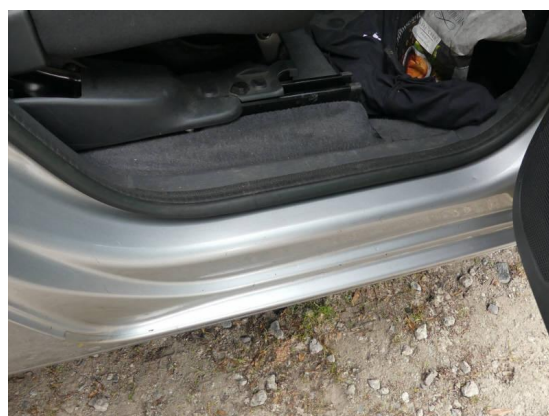
Bild 42: Karosserie / Einstieg hinten rechts Delle und Kratzer
