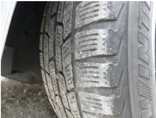
Bild 45: Reifen - Felge / Winterreifen rissig/porös kurz vor Verschleißgrenze
