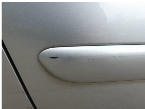
Bild 39: Karosserie / Tür hinten rechts Kratzer
