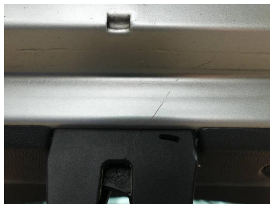
Bild 14: Karosserie / Stoßfänger hinten gebrochen
