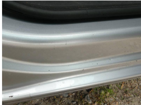
Bild 44: Karosserie / Einstieg hinten rechts Delle und Kratzer
