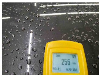
Lackstärke Seitenwand hinten rechts
