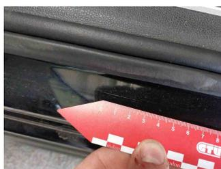
18 - Kotflügel vorne rechts - Kratzer - Akzeptabel (Gebrauchsspur)
