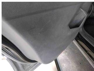
4 - Schwellerverkleidung hinten rechts - Kratzer - Akzeptabel (Gebrauchsspur)
