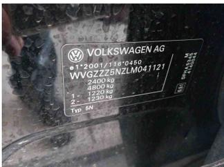
Fahrzeug - Typenschild/Fahrgestellnummer
