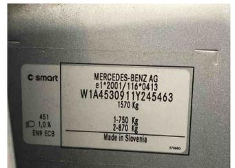
Fahrzeug - Typenschild/Fahrgestellnummer
