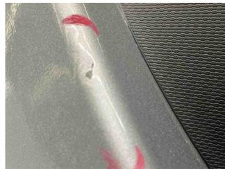
3 - Einstiegsschweller vorne links - Delle(n) und Kratzer - Instandsetzen + lackieren
