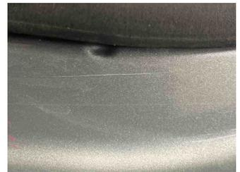
4 - Tür vorne rechts - Delle(n) und Kratzer - Instandsetzen + lackieren
