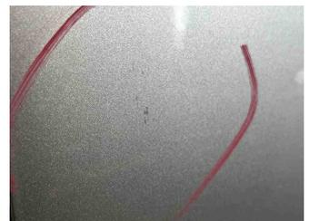
5 - Stoßfänger hinten - Delle(n) und Kratzer - Lackieren
