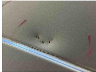
2 - Tür vorne links - Delle(n) und Kratzer - Instandsetzen + lackieren
