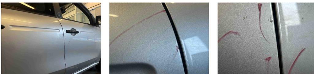
10 - Kotflügel hinten links - Kratzer - Auslegen + Polieren
