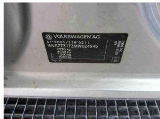
Fahrzeug - Typenschild/Fahrgestellnummer
