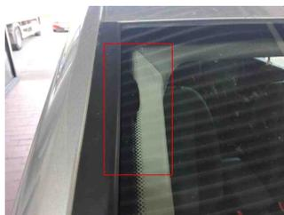
2 - Türverkleidung Zierleiste vorne links - Kratzer - Ersetzen
