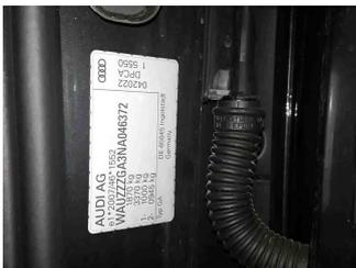
Fahrzeug - Typenschild/Fahrgestellnummer
