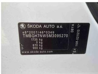
Fahrzeug - Typenschild/Fahrgestellnummer
