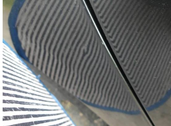
Bild 32: Karosserie / Seitenteil rechts leicht deformiert und zerkratzt
