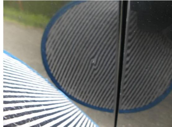
Bild 38: Karosserie / Tür hinten rechts Dellen und Kratzer
