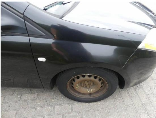
Bild 45: Karosserie / Kotflügel rechts deformiert
