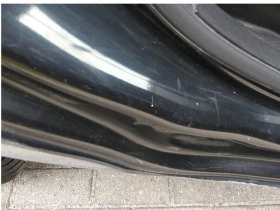
Bild 35: Karosserie / Einstieg hinten rechts zerkratzt
