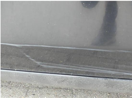
Bild 15: Karosserie / Tür hinten links leicht deformiert und zerkratzt
