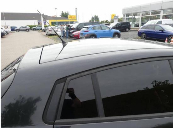
Bild 31: Karosserie / Dachholm rechts Lackverätzung
