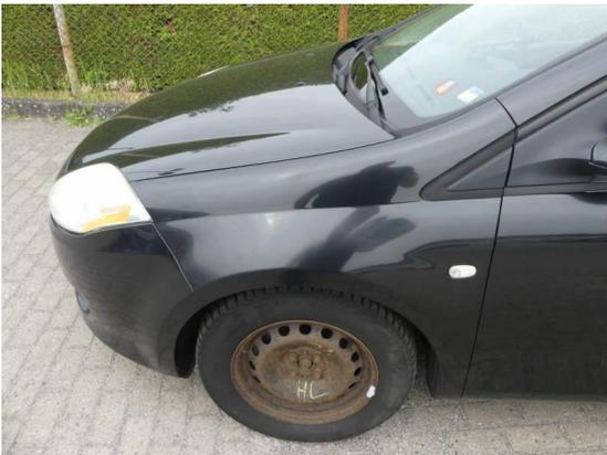
Bild 63: Karosserie / Kotflügel links Steinschläge und Kratzer
