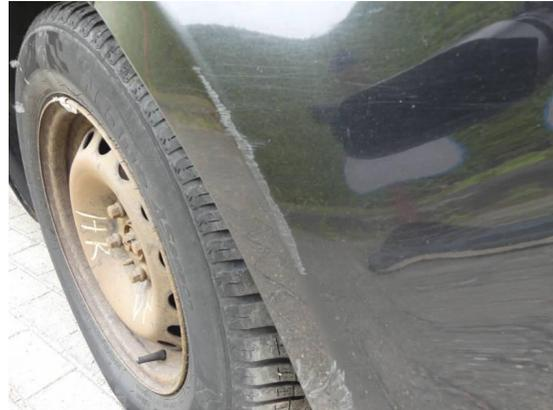
Bild 56: Karosserie / Stoßfänger vorn zerkratzt
