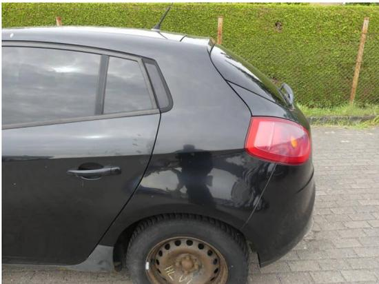
Bild 21: Karosserie / Seitenteil links leicht deformiert und zerkratzt
