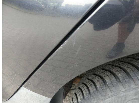
Bild 20: Karosserie / Seitenteil links leicht deformiert und zerkratzt
