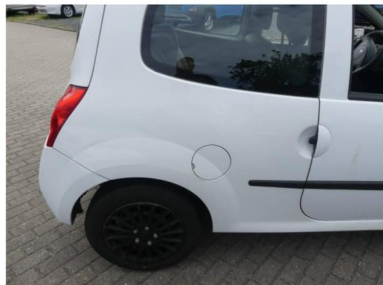
Bild 4: Karosserie / Seitenteil rechts zerkratzt
