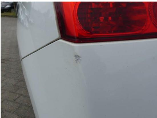
Bild 21: Karosserie / Stoßfänger hinten leicht deformiert und zerkratzt
