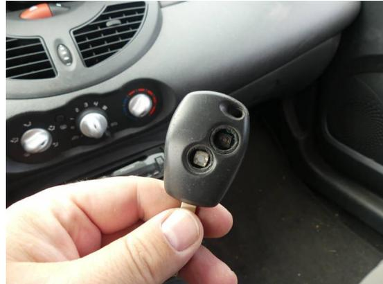
Bild 8: Technik / Schlüsselfernbedienung eine ohne Funktion und Gehäuse gebrochen
