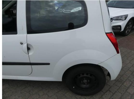
Bild 20: Karosserie / Seitenteil links zerkratzt
