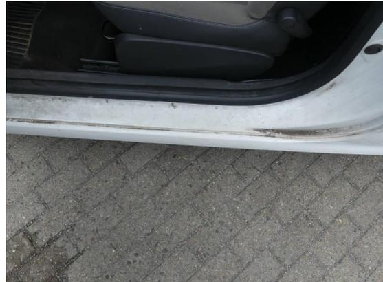
Bild 14: Karosserie / Einstieg links zerkratzt
