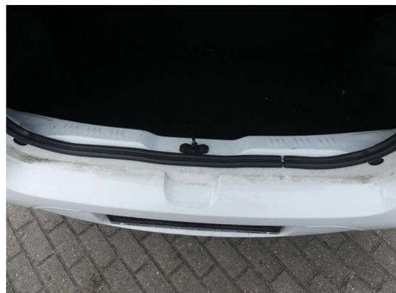
Bild 24: Karosserie / Ladekante Kofferraum zerkratzt
