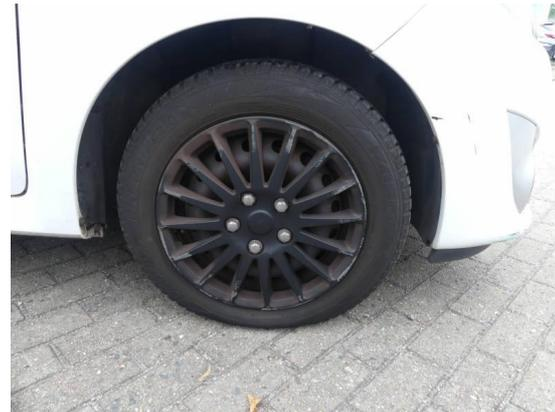
Bild 28: Reifen - Felge / Radkappen zerkratzt
