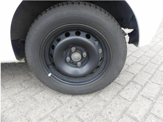
Bild 25: Reifen - Felge / Radkappe hinten links fehlt
