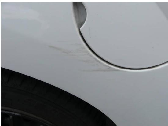
Bild 3: Karosserie / Seitenteil rechts zerkratzt
