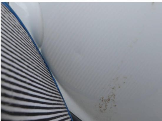
Bild 5: Karosserie / Tür rechts Delle
