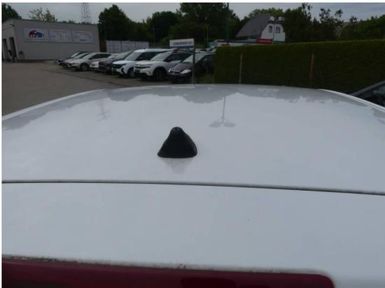
Bild 27: Technik / Antennenstab fehlt
