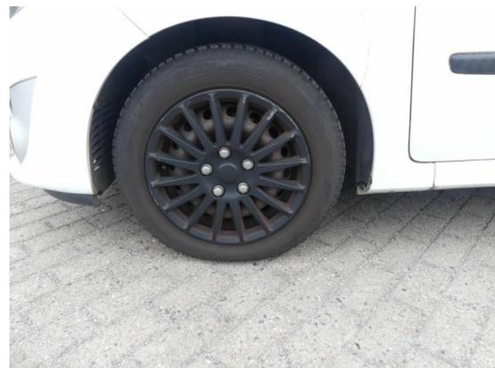
Bild 30: Reifen - Felge / Radkappen zerkratzt
