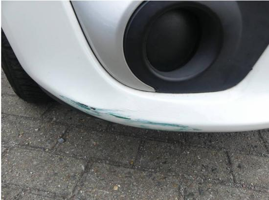
Bild 1: Karosserie / Stoßfänger vorn leicht deformiert und zerkratzt
