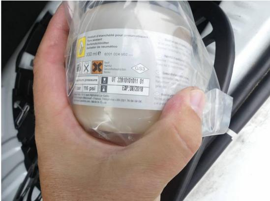
Bild 31: Reifen - Felge / Reifendichtmittel abgelaufen
