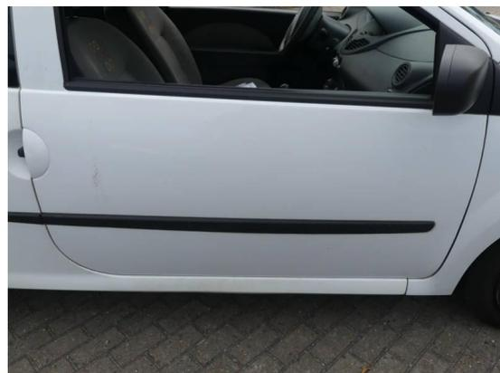
Bild 6: Karosserie / Tür rechts Delle
