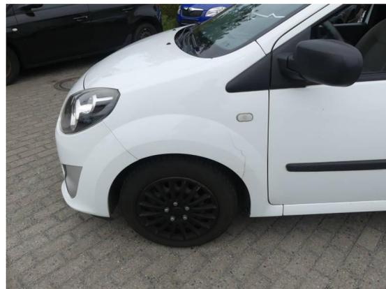
Bild 10: Karosserie / Kotflügel links gebrochen
