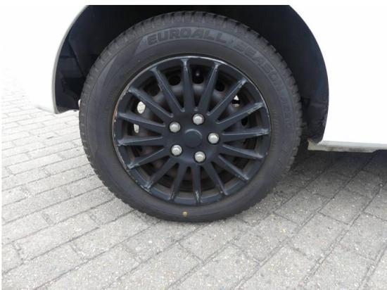
Bild 29: Reifen - Felge / Radkappen zerkratzt
