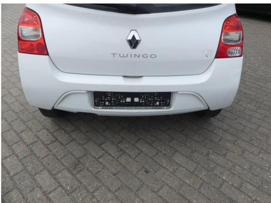
Bild 23: Karosserie / Stoßfänger hinten leicht deformiert und zerkratzt
