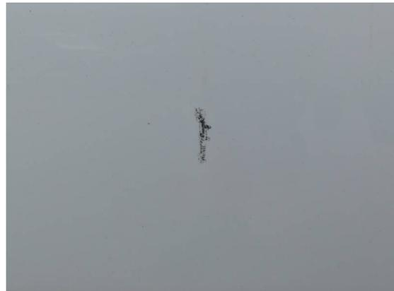
Bild 16: Karosserie / Tür links Delle und Kratzer
