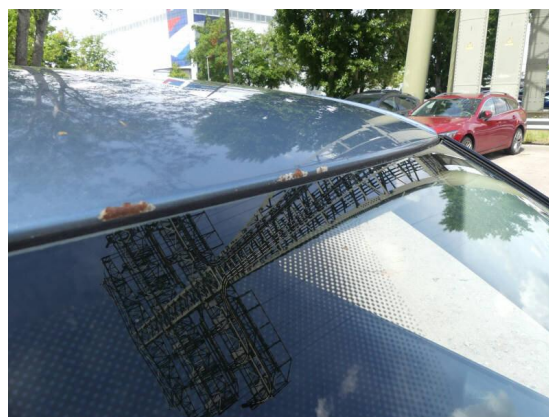
Bild 16: Karosserie / Dachkante vorn Korrosion
