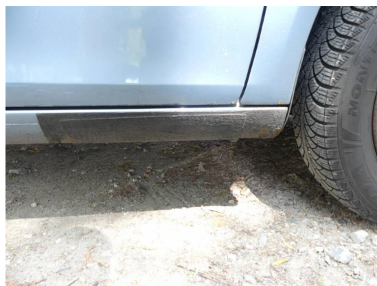
Bild 10: Karosserie / Schweller rechts Korrosion
