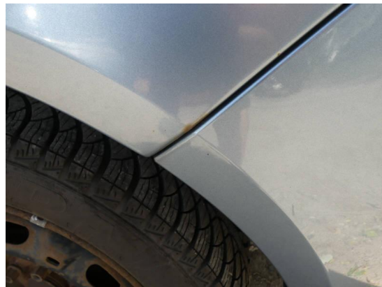
Bild 2: Karosserie / Seitenteil links Korrosion
