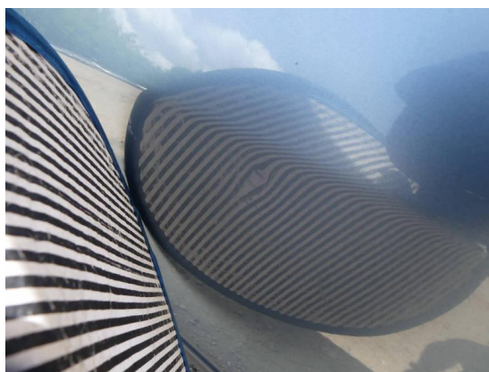
Bild 28: Karosserie / Tür hinten links leicht deformiert und zerkratzt
