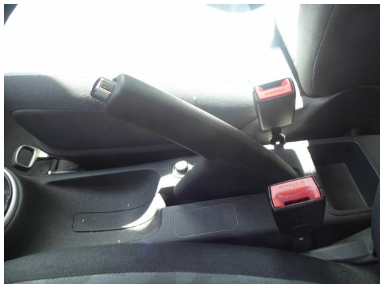
Bild 13: Technik / Handbremse ohne Funktion und Hebelweg zu lang
