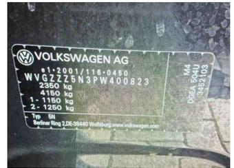
Fahrzeug - Typenschild/Fahrgestellnummer
