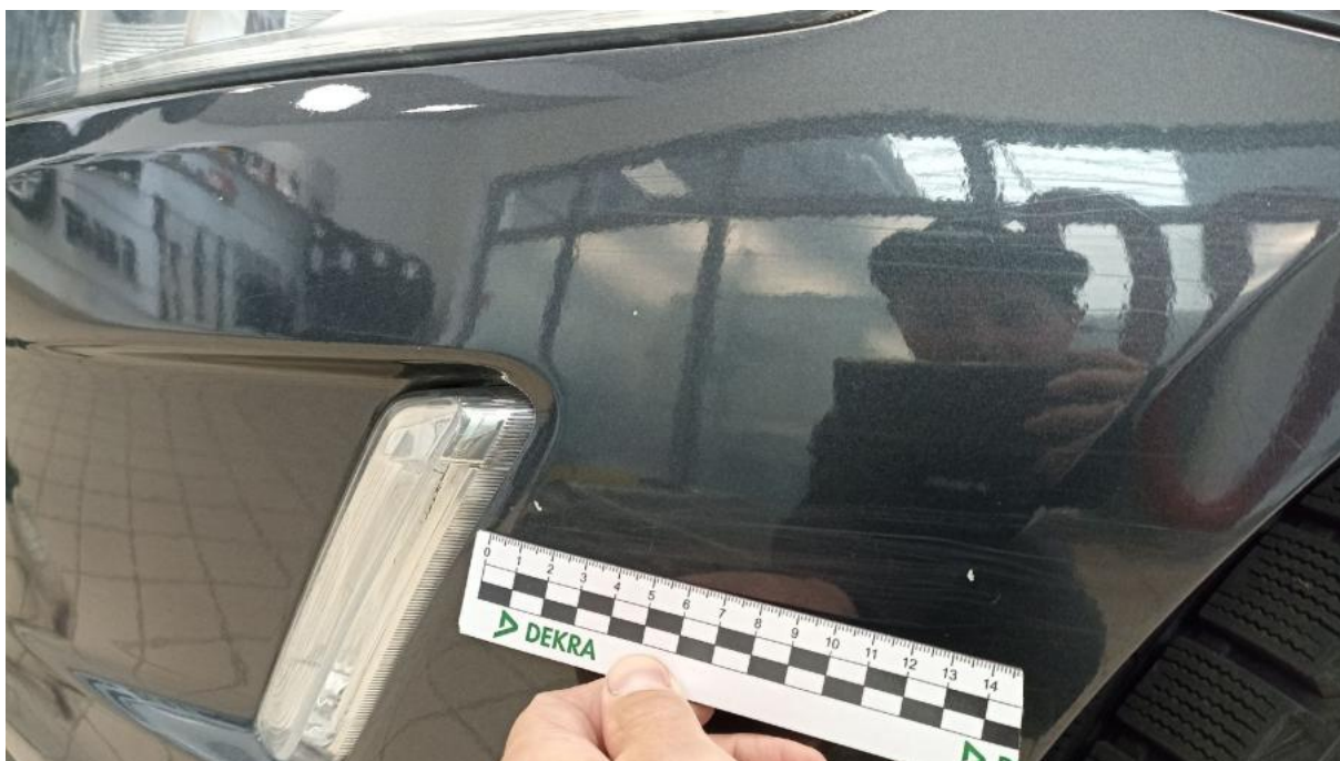
Fot. 39 Zderzak - Rysa/odprysk 1
