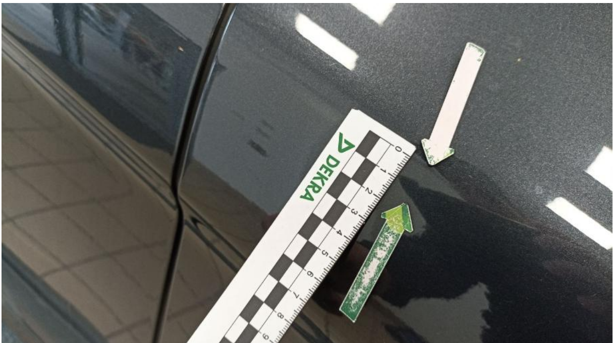
Fot. 42 Błotnik przedni P - Wgniecenie/odkształcenie 1
