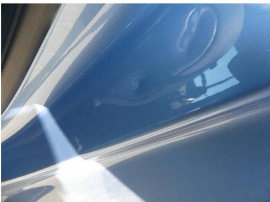
Bild 35: Karosserie / Einstieg hinten links leicht deformiert und Kratzer
