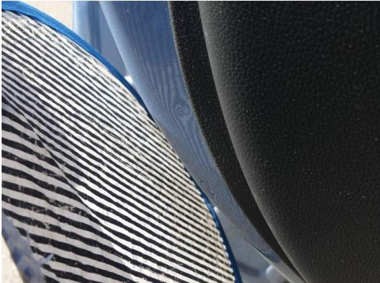
Bild 31: Karosserie / Tür vorne links leicht deformiert und Kratzer
