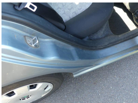
Bild 29: Karosserie / Einstieg hinten rechts zerkratzt mit Korrosionsansatz
