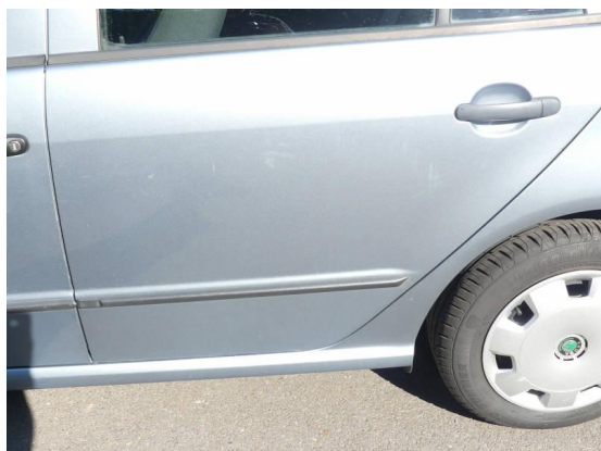
Bild 13: Karosserie / Tür hinten links leicht deformiert und zerkratzt
