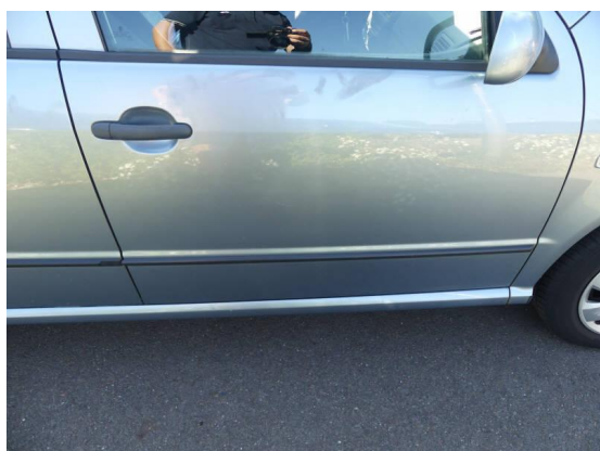
Bild 41: Karosserie / Tür vorne rechts Dellen und zerkratzt
