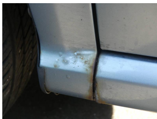
Bild 52: Karosserie / Kotflügel links Korrosion unter Lack und zerkratzt
