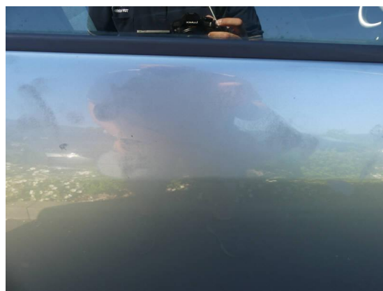
Bild 34: Karosserie / Tür hinten rechts Delle und zerkratzt
