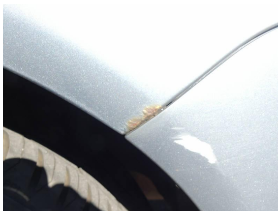
Bild 14: Karosserie / Seitenteil links Korrosion und deformiert
