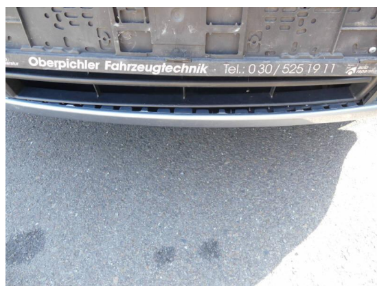
Bild 48: Karosserie / Kühlergrill im Stoßfänger ausgehackt
