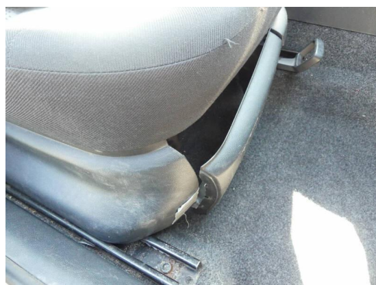
Bild 36: Innenraum / Sitzverkleidung vorne rechts abgebrochen
