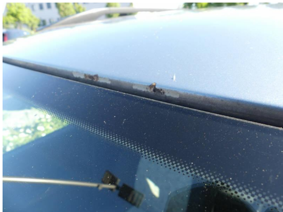
Bild 1: Karosserie / Dach und Dachkante vorn zerkratzt und Steinschläge mit
