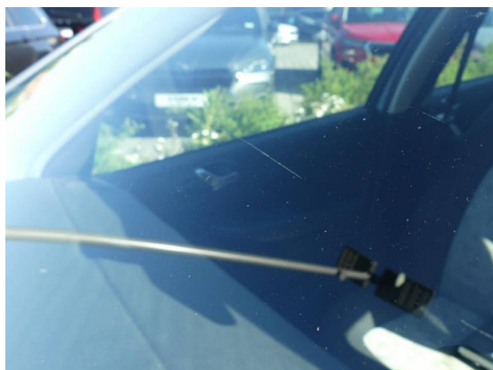
Bild 31: Karosserie / Frontscheibe zerkratzt
