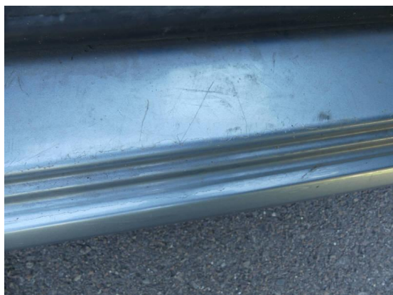
Bild 37: Karosserie / Einstieg vorne rechts zerkratzt
