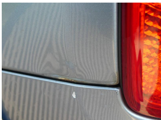
Bild 15: Karosserie / Seitenteil links Korrosion und deformiert
