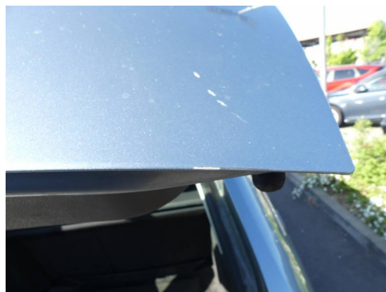
Bild 20: Karosserie / Heckklappe zerkratzt mit Korrosionsansatz
