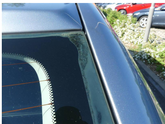
Bild 23: Karosserie / Heckscheibe zieht Luft
