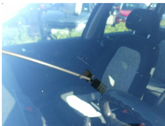
Bild 30: Karosserie / Frontscheibe zerkratzt
