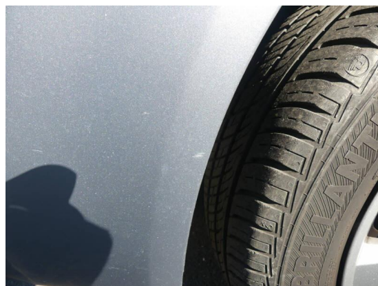
Bild 50: Karosserie / Stoßfänger vorn Kratzer
