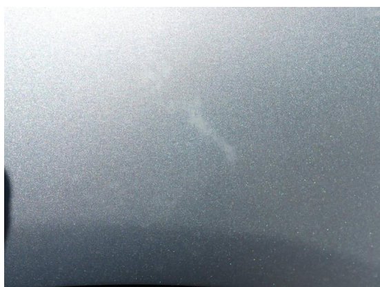
Bild 53: Karosserie / Kotflügel links Korrosion unter Lack und zerkratzt
