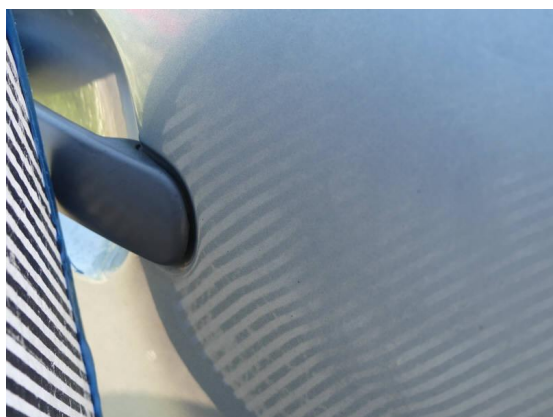
Bild 33: Karosserie / Tür hinten rechts Delle und zerkratzt
