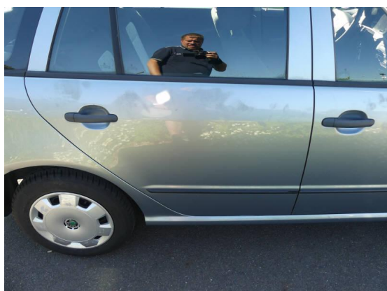
Bild 35: Karosserie / Tür hinten rechts Delle und zerkratzt
