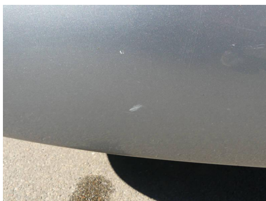
Bild 18: Karosserie / Stoßfänger hinten zerkratzt
