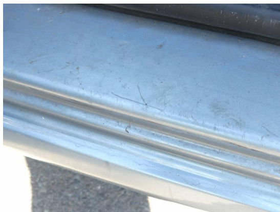
Bild 4: Karosserie / Einstieg vorne links zerkratzt
