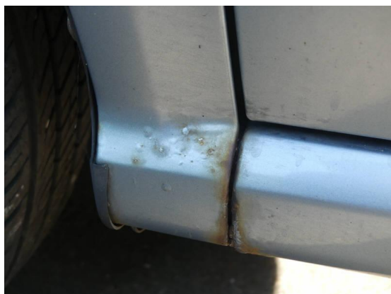
Bild 55: Karosserie / Schweller vorne links Korrosionsansatz
