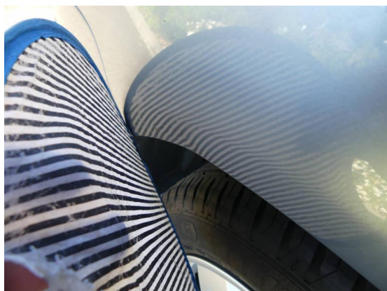
Bild 25: Karosserie / Seitenteil rechts leicht deformiert und zerkratzt
