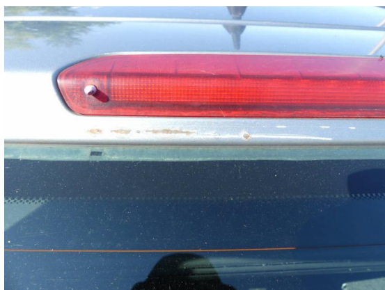
Bild 21: Karosserie / Heckklappe zerkratzt mit Korrosionsansatz
