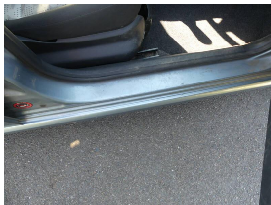
Bild 38: Karosserie / Einstieg vorne rechts zerkratzt
