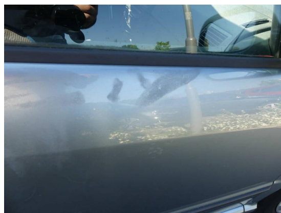
Bild 40: Karosserie / Tür vorne rechts Dellen und zerkratzt
