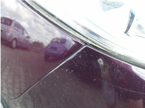
Bild 25: Karosserie / Stoßfänger vorn zerkratzt
