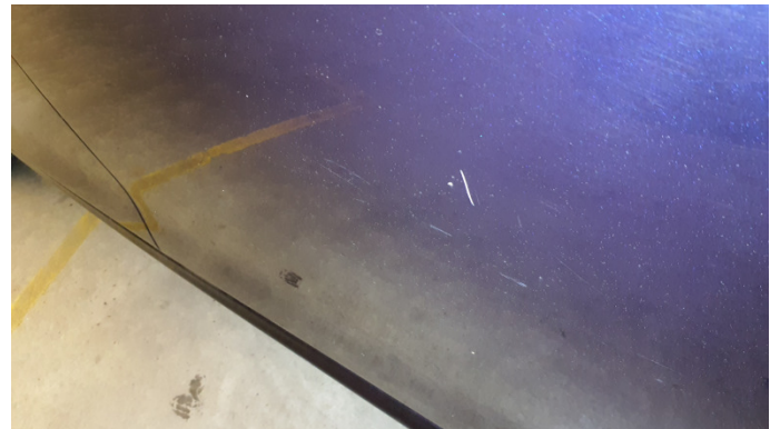
7. Tür Vorne - Rechts Kratzer -
