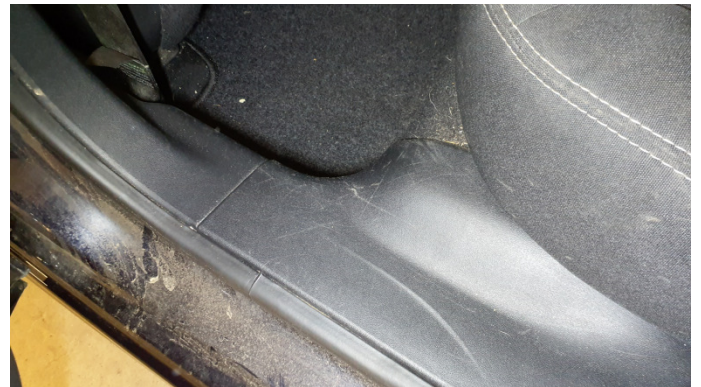
28. Einstiegsverkleidung Hinten links Kratzer -
