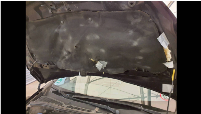
24. Dämmmatte Motorhaube Beschädigt -
