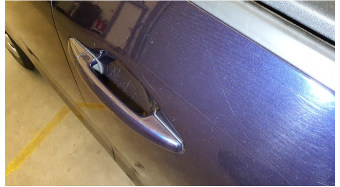
7. Tür Vorne - Rechts Kratzer -
