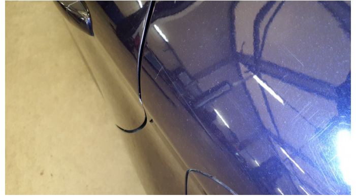
11. Seitenwand - Hinten - Links Kratzer -
