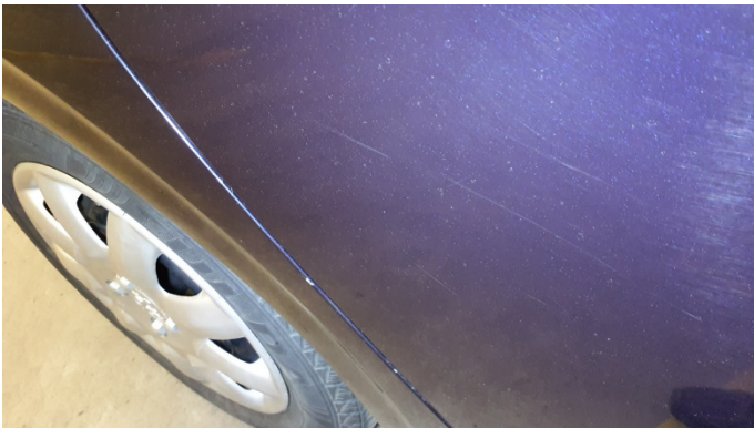
8. Tür Hinten - Rechts Kratzer -
