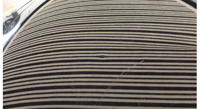
2. Dach Dellen / Beulen -
