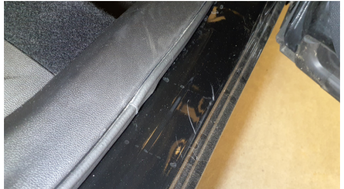
3. Türeinstieg Hinten - Rechts Kratzer -
