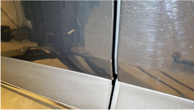
7. Tür Vorne - Links Kratzer -
