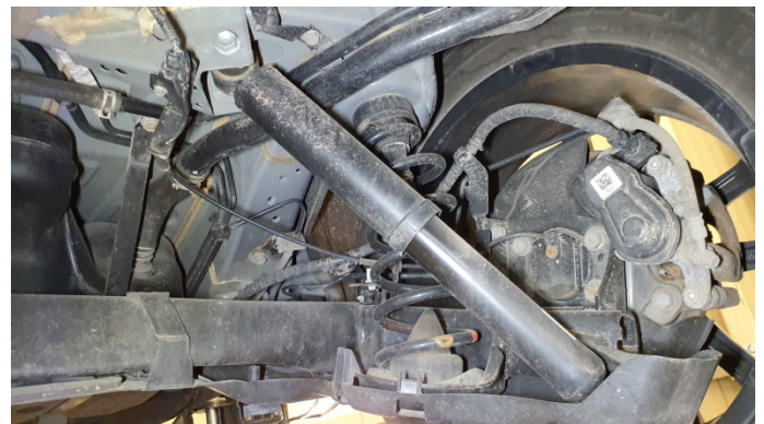
30. Stoßdämpfer Hinten Riss -
