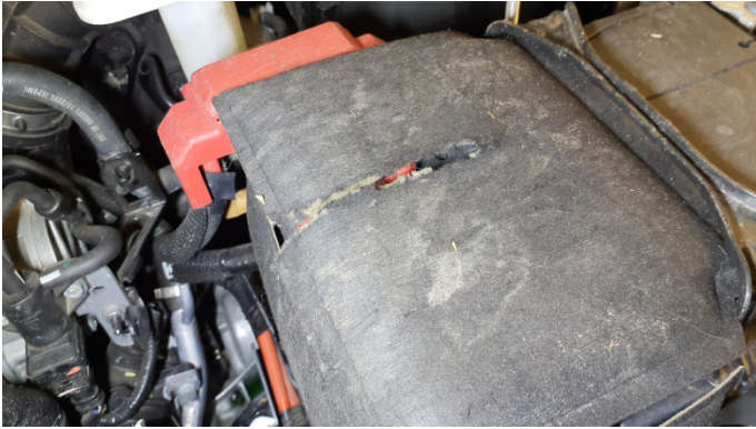
24. Dämmmatte Batterie Beschädigt -
