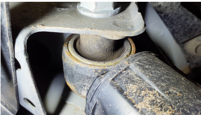
30. Stoßdämpfer Hinten Riss -
