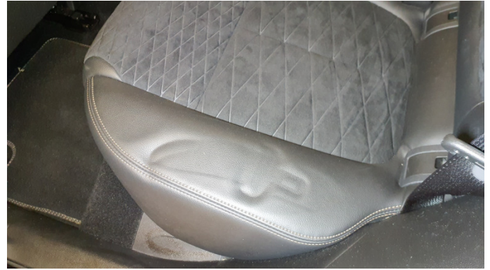
20. Rücksitzbank Verformt (stark) -
