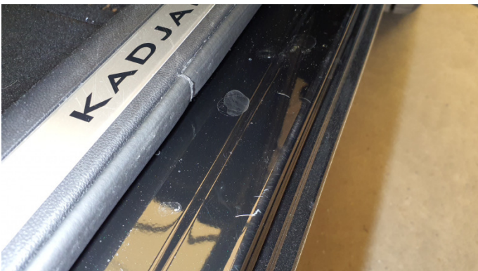
4. Türeinstieg Vorne - Rechts Kratzer -
