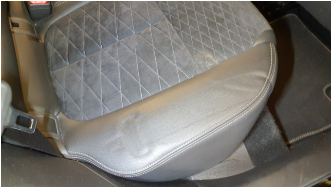
20. Rücksitzbank Verformt (stark) -
