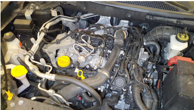
25. Ladeluftschlauch vor LLK Beschädigt -
