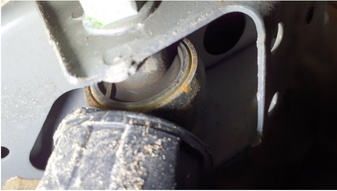
30. Stoßdämpfer Hinten Riss -
