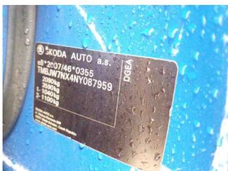
Fahrzeug - Typenschild/Fahrgestellnummer
