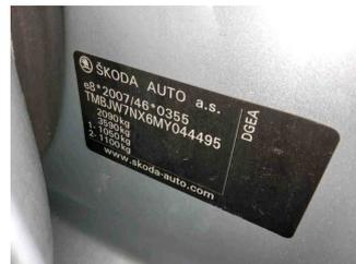
Fahrzeug - Typenschild/Fahrgestellnummer
