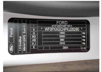
Fahrzeug - Typenschild/Fahrgestellnummer
