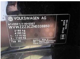
Fahrzeug - Typenschild/Fahrgestellnummer
