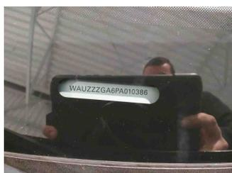
Fahrzeug - Typenschild/Fahrgestellnummer
