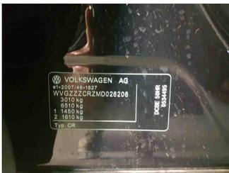
Fahrzeug - Typenschild/Fahrgestellnummer
