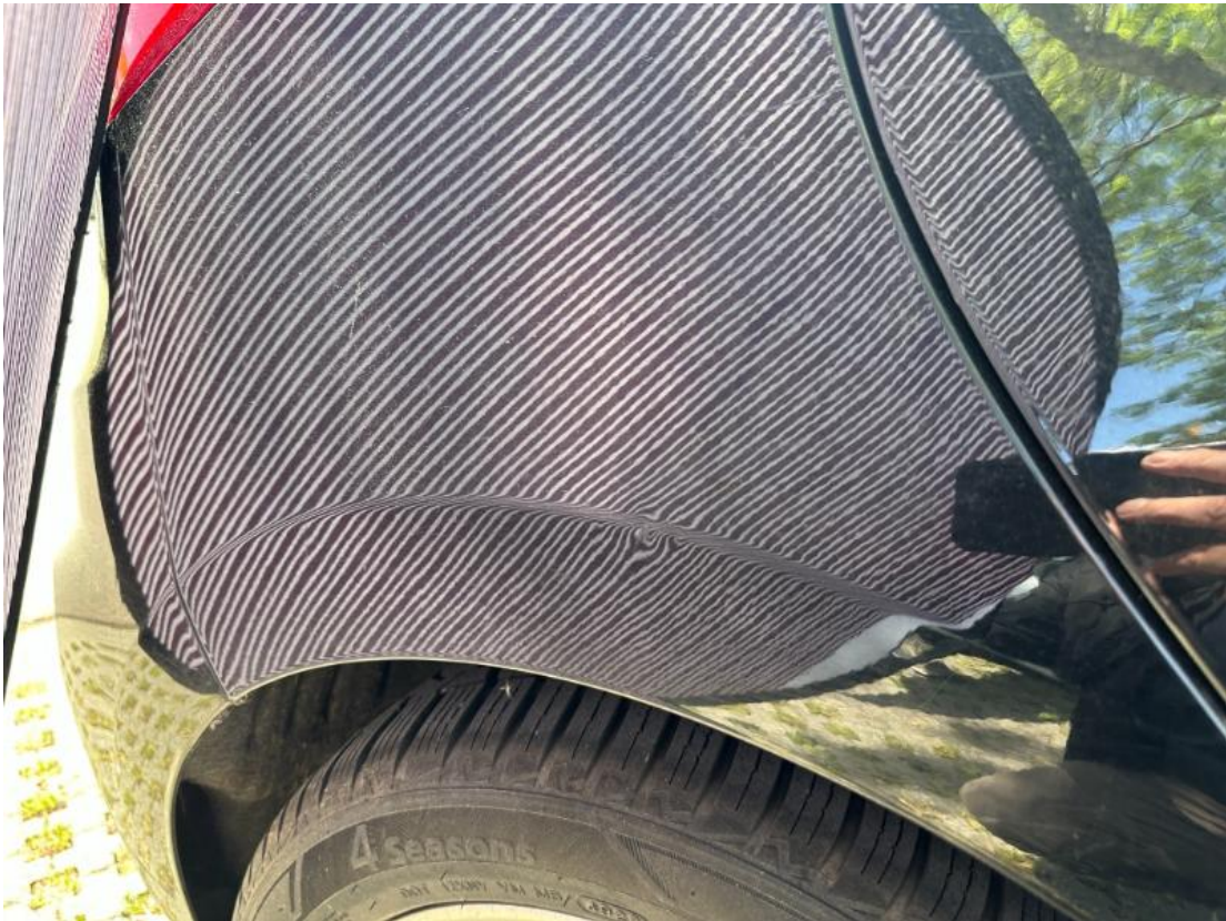
8. Seitenwand hinten rechts - Delle
