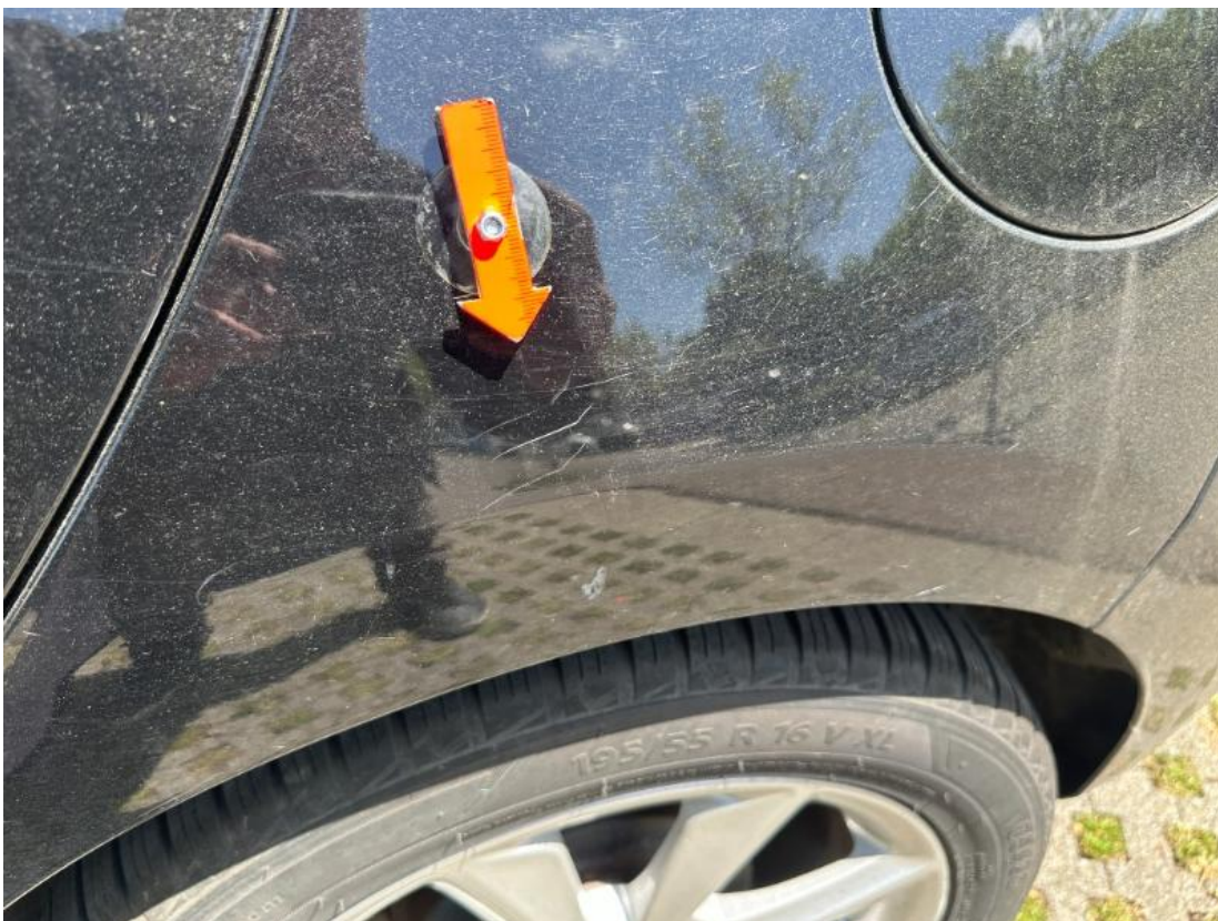
3. Seitenwand hinten links - Verkratzt
