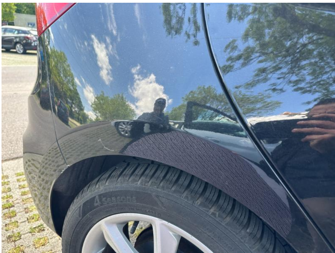
8. Seitenwand hinten rechts - Delle
