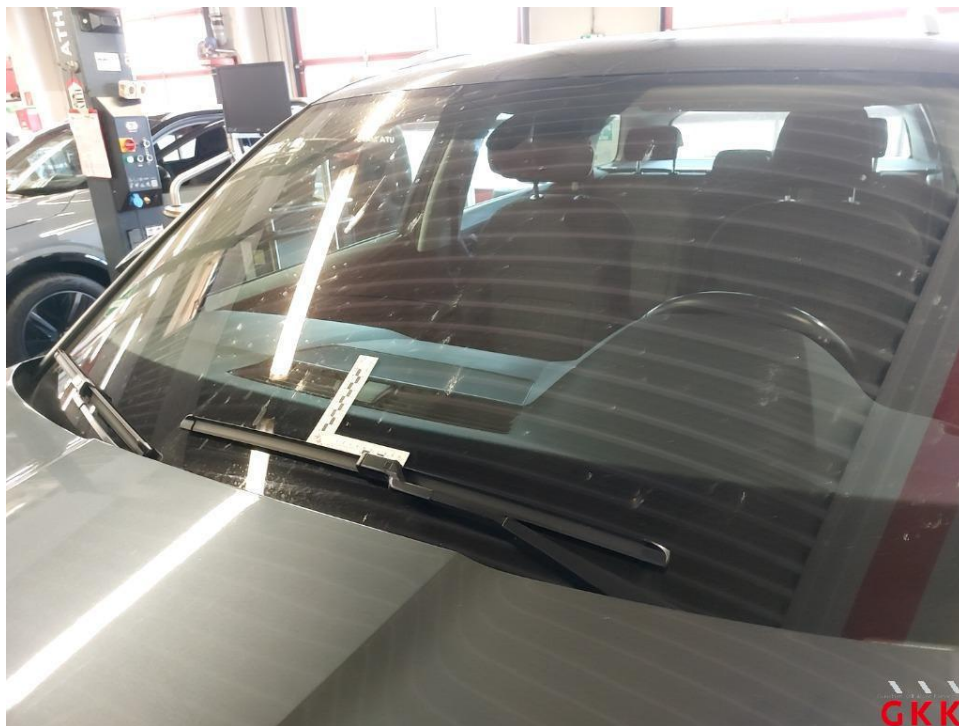
Bild 18 Frontscheibe, Steinschlag mit Rissbildung, ersetzen
