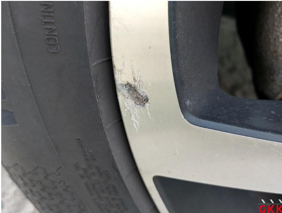
Bild 19 LM-Rad, vorne links, beschädigt, ersetzen
