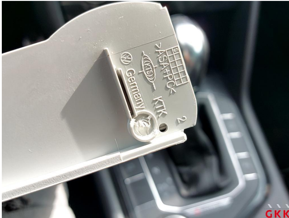
Bild 15 Himmel, Ablagefach, beschädigt, ersetzen
