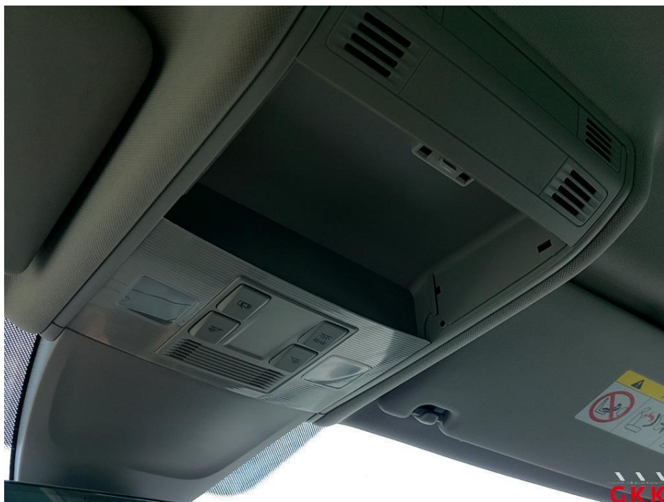
Bild 14 Himmel, Ablagefach, beschädigt, ersetzen
