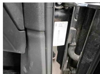
Fahrzeug - Typenschild/Fahrgestellnummer
