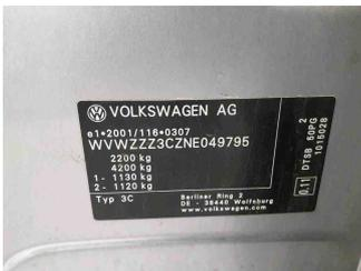
Fahrzeug - Typenschild/Fahrgestellnummer
