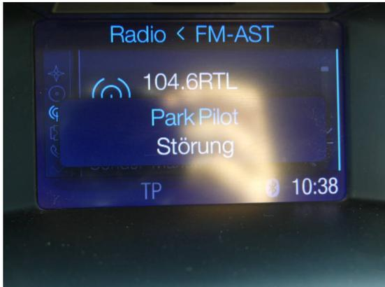
Bild 19: Technik / Parkpilot ohne Funktion ( signalisiert Störung )
