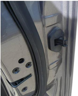
Bild 9: Technik / automatischer Türkantenschoner vorne rechts abgebrochen
