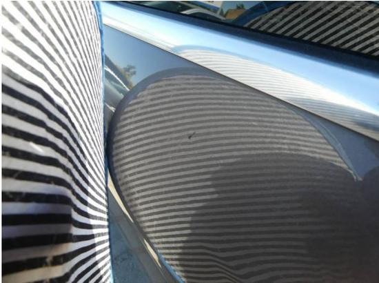
Bild 25: Karosserie / Tür hinten links Dellen und zerkratzt
