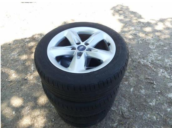
Bild 29: Reifen - Felge / Felge vorne links ( Sommerradsatz ) Bordsteinschaden
