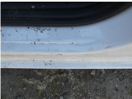
Bild 23: Karosserie / Einstieg vorne links zerkratzt
