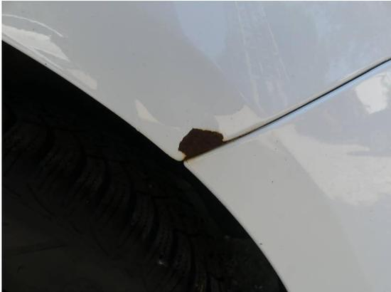
Bild 25: Karosserie / Seitenteil links Korrosion
