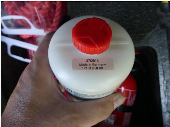
Bild 27: Reifen - Felge / Reifendichtmittel abgelaufen
