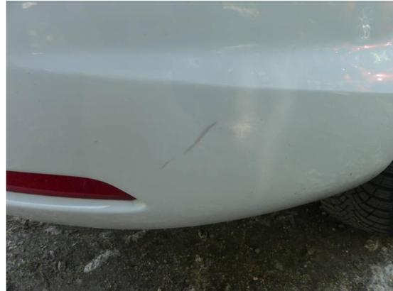
Bild 2: Karosserie / Stoßfänger hinten Kratzer
