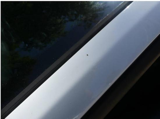
Bild 21: Karosserie / A-Säule links Steinschlag mit Korrosionsansatz
