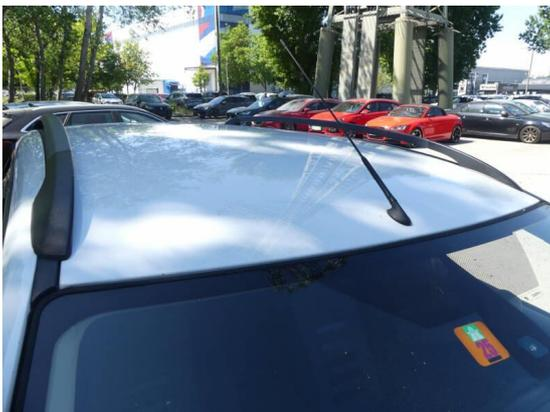
Bild 15: Karosserie / Dachkante vorn Steinschlag mit Korrosion
