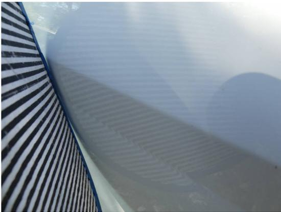
Bild 9: Karosserie / Tür vorne rechts leicht deformiert
