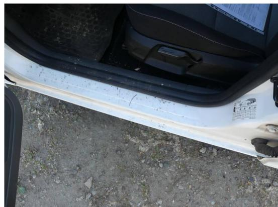
Bild 24: Karosserie / Einstieg vorne links zerkratzt
