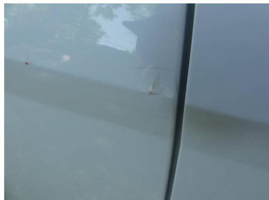
Bild 6: Karosserie / Tür hinten rechts leicht deformiert und zerkratzt
