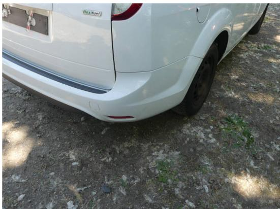
Bild 3: Karosserie / Stoßfänger hinten Kratzer
