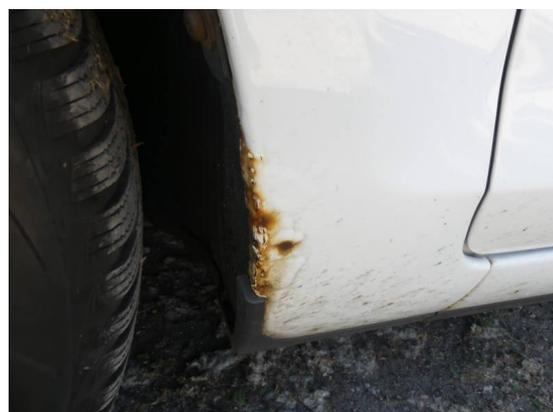
Bild 18: Karosserie / Kotflügel links Korrosion
