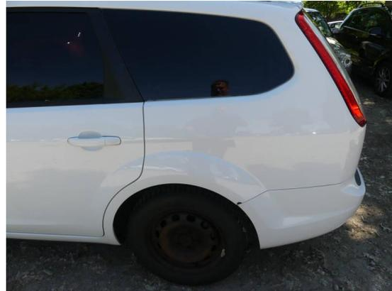
Bild 26: Karosserie / Seitenteil links Korrosion
