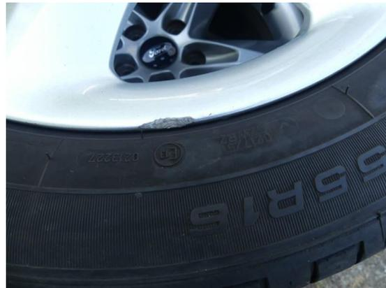
Bild 28: Reifen - Felge / Felge vorne links ( Sommerradsatz ) Bordsteinschaden
