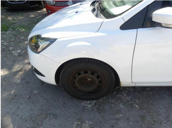
Bild 19: Karosserie / Kotflügel links Korrosion
