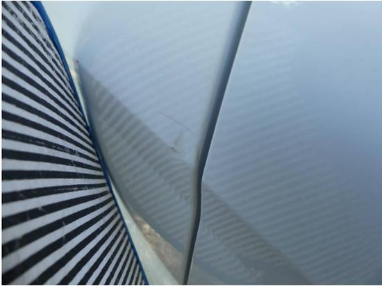
Bild 7: Karosserie / Tür hinten rechts leicht deformiert und zerkratzt
