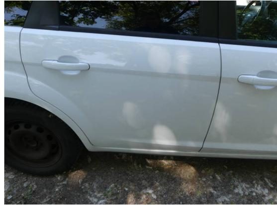
Bild 8: Karosserie / Tür hinten rechts leicht deformiert und zerkratzt
