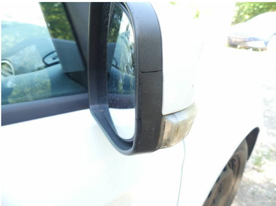
Bild 11: Karosserie / Spiegelgehäuse rechts gebrochen
