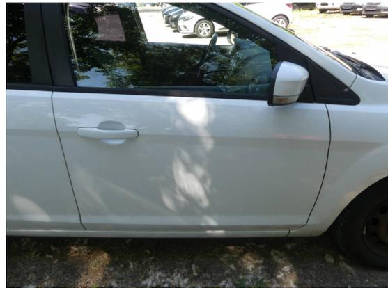
Bild 10: Karosserie / Tür vorne rechts leicht deformiert
