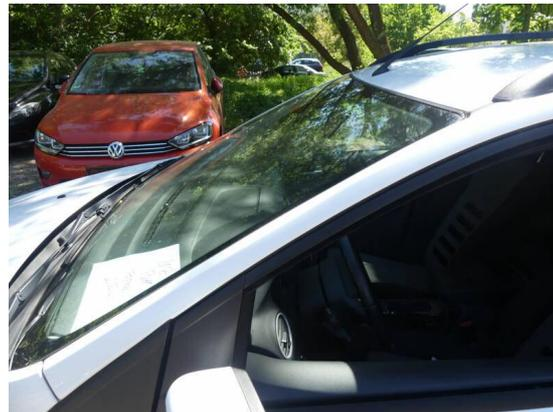
Bild 22: Karosserie / A-Säule links Steinschlag mit Korrosionsansatz
