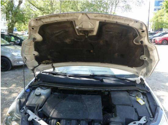
Bild 13: Technik / Dämmmatte Motorhaube zerrissen
