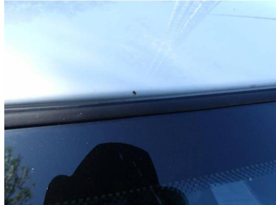
Bild 14: Karosserie / Dachkante vorn Steinschlag mit Korrosion
