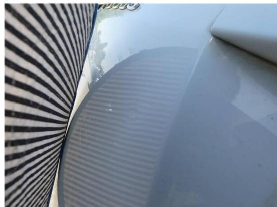
Bild 4: Karosserie / Heckklappe Delle
