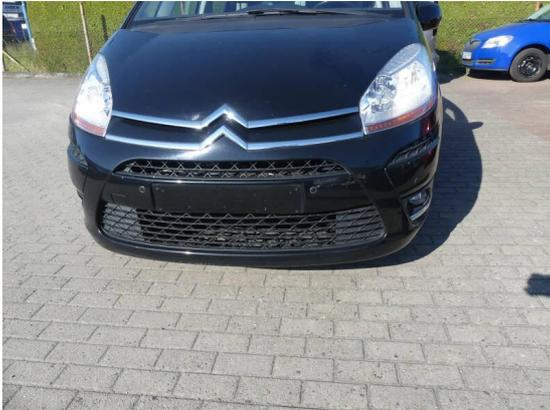
Bild 31: Karosserie / Stoßfänger vorn zerkratzt
