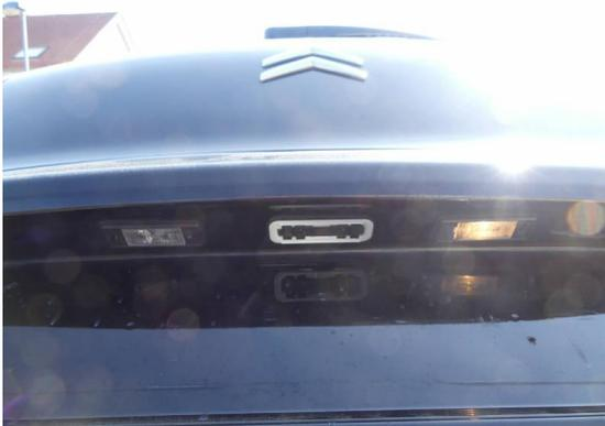
Bild 13: Technik / Kennzeichenleuchte links ohne Funktion
