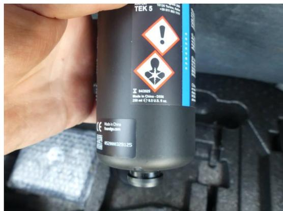
Bild 12: Reifen - Felge / Reifendichtmittel abgelaufen
