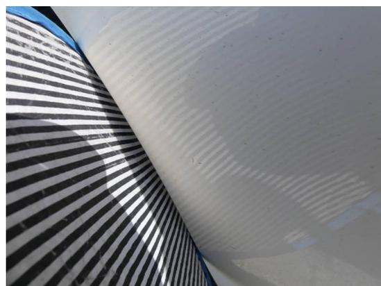
Bild 6: Karosserie / Seitenteil rechts Dellen mit Kratzer
