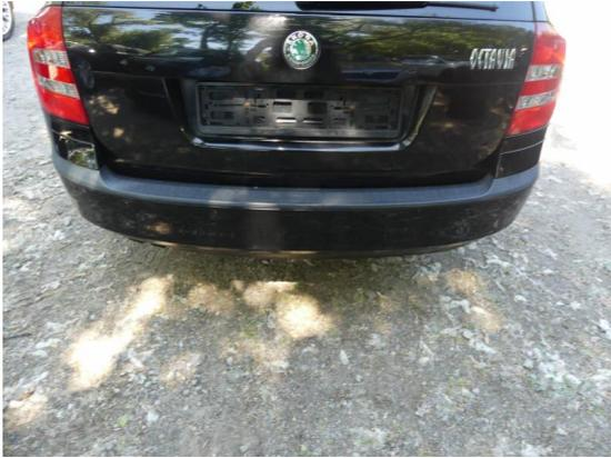
Bild 43: Karosserie / Stoßfänger hinten zerkratzt
