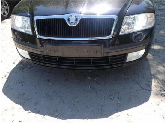
Bild 25: Karosserie / Stoßfänger vorn zerkratzt
