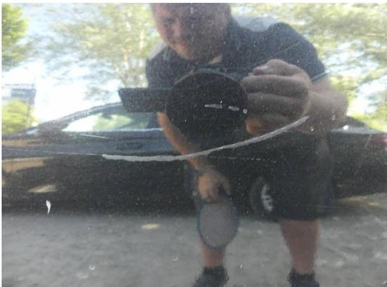
Bild 35: Karosserie / Tür hinten links zerkratzt
