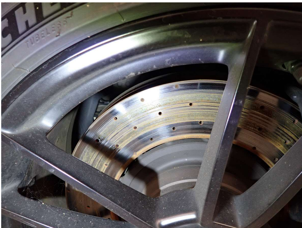
Bild 18 Bremsscheibe vorn links von Rost befallen
