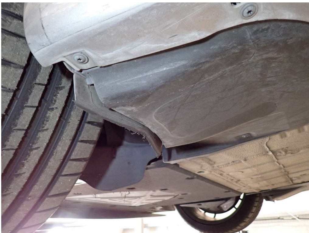
Bild 16 Radhausschale vorn rechts vorn verschrammt
