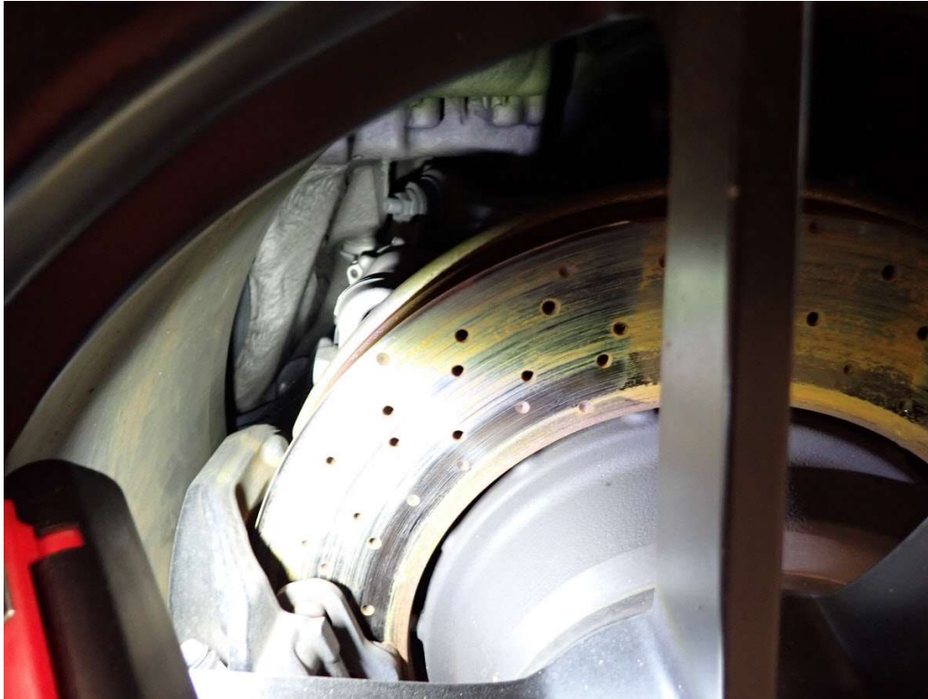
Bild 19 Bremsscheibe hinten links von Rost befallen
