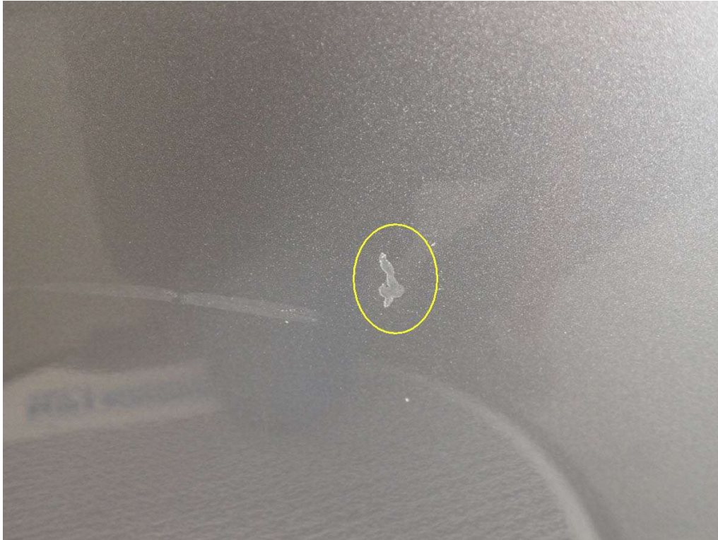
Bild 11 Türe links Lackschaden
