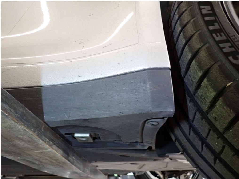
Bild 12 Schwellerblende links verkratzt
