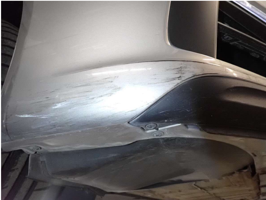
Bild 15 Frontspoiler oben und Steinschlagfolie Bugverkleidung verschrammt
