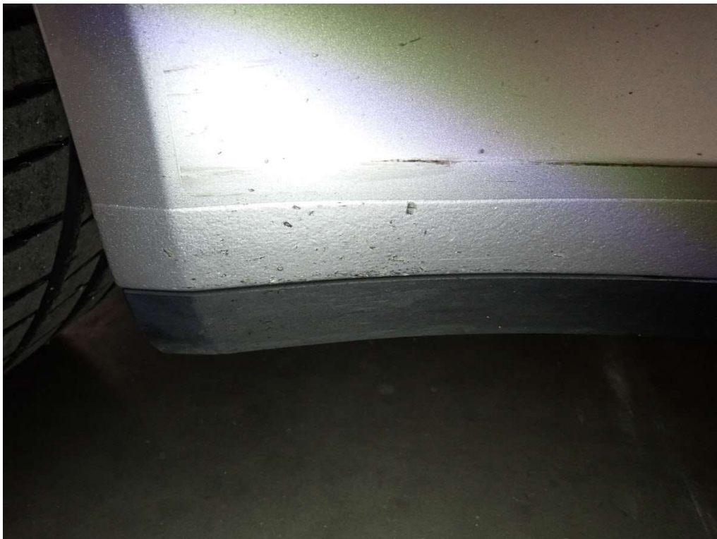
Bild 22 Altschaden Steinschlagschäden Seitenteil hinten rechts
