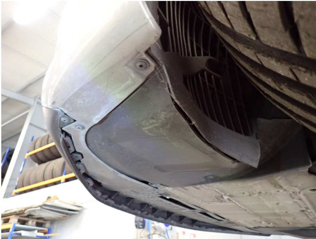
Bild 17 Radhausschale vorn links vorn verschrammt
