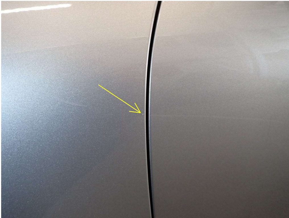
Bild 9 Kotflügel vorn links Schutzfolie verkratzt
