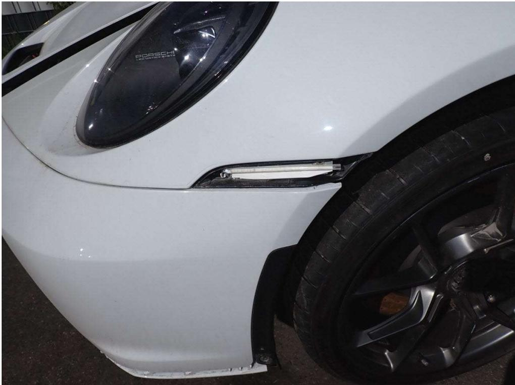
Bild 17 Blinkleuchte seitlich links
