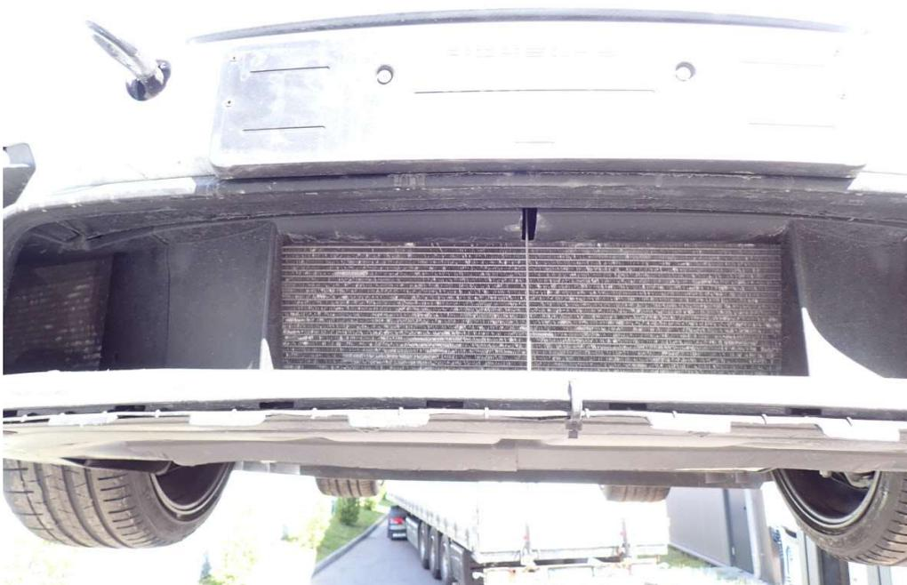
Bild 16 Zusatzwasserkühler
