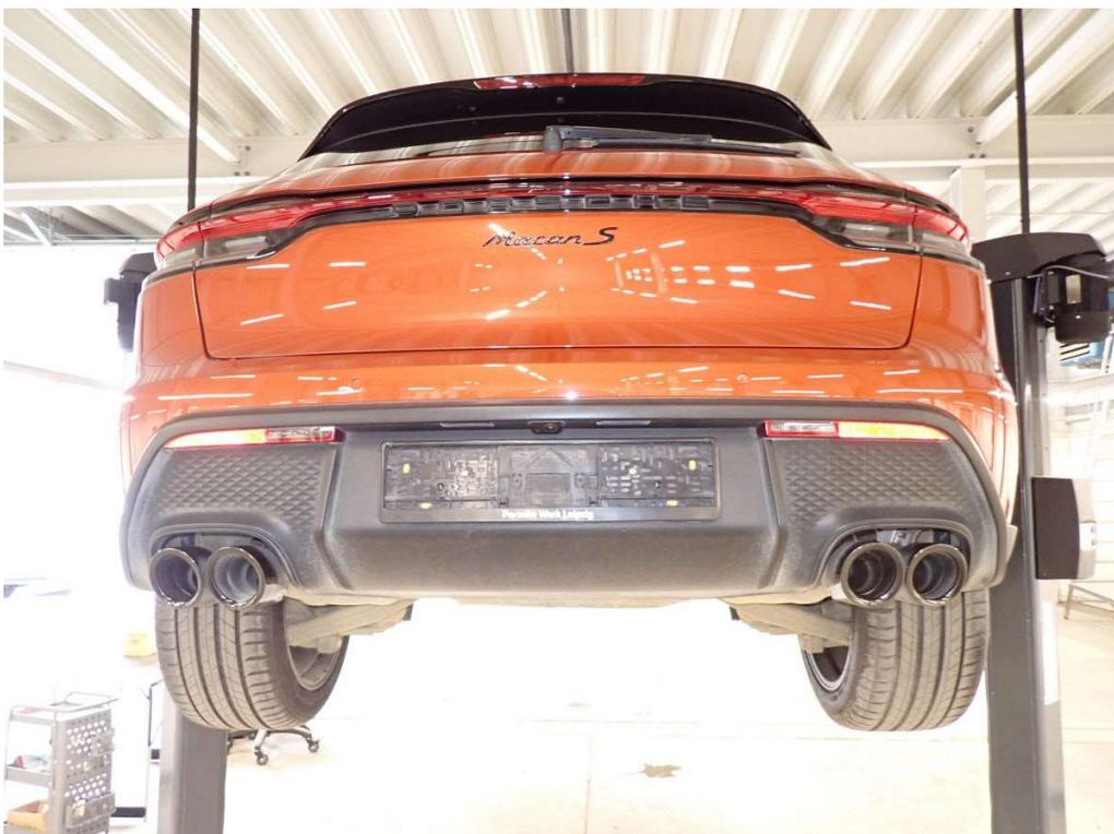
Bild 26 Heckverkleidung mit Anbauteilen
