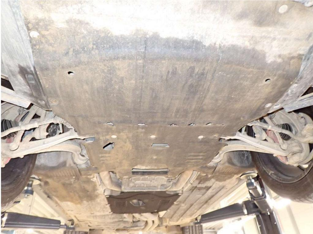
Bild 33 Unterbodenverkleidung vorn
