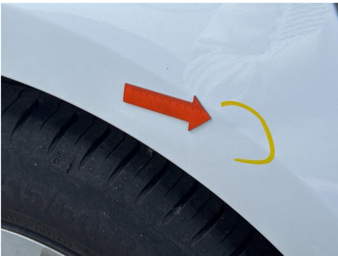
1. Seitenwand hinten rechts - Delle
