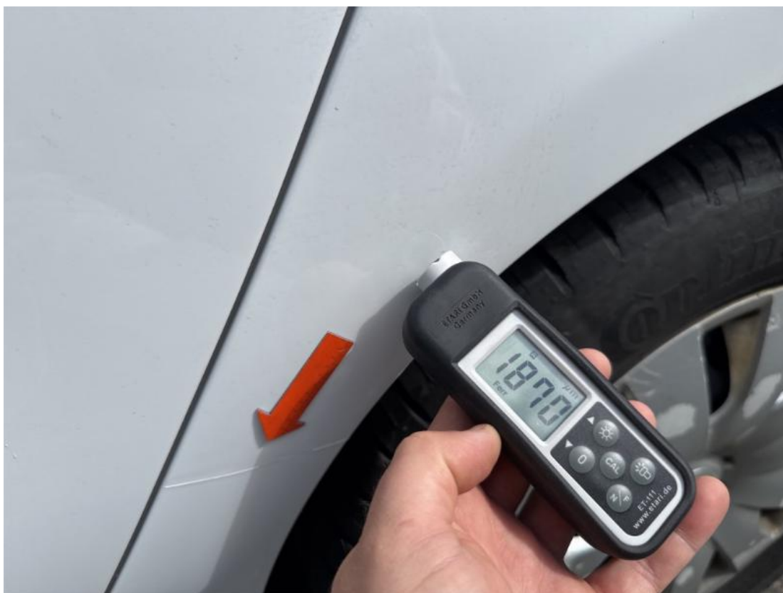
4. Seitenwand hinten links - Instandsetzung nicht sach- und fachgerecht
