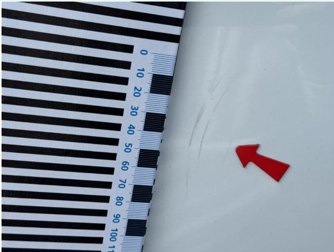
2. Tür hinten rechts - Lackbeschädigung
