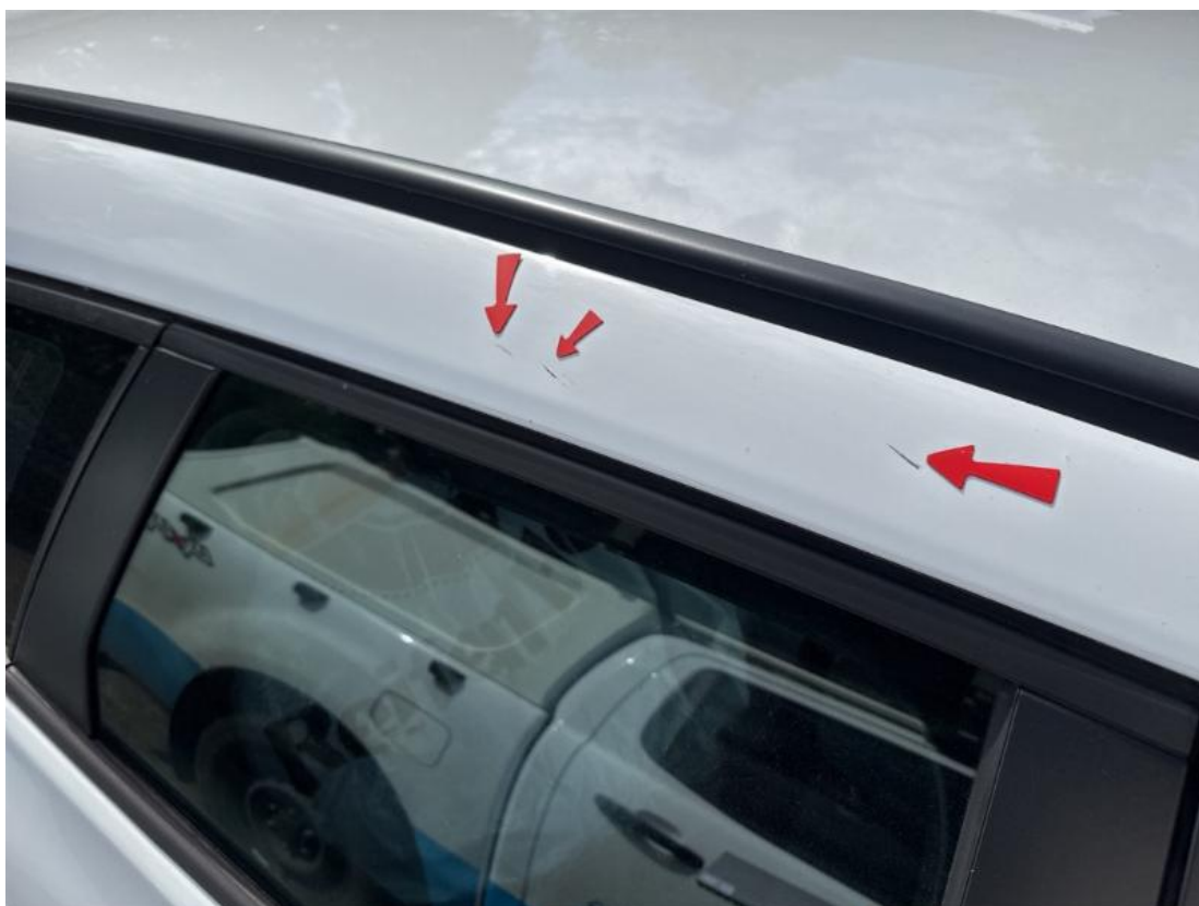
3. Dachholm rechts - Lackbeschädigung
