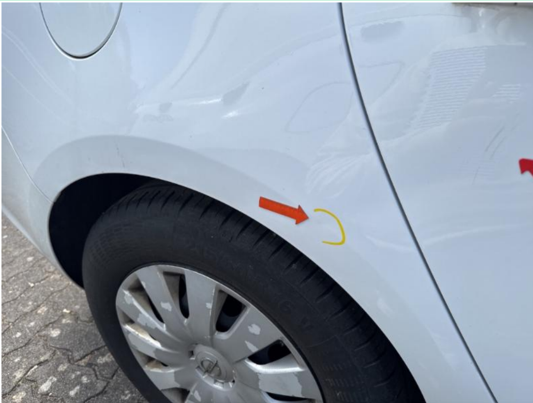
1. Seitenwand hinten rechts - Delle
