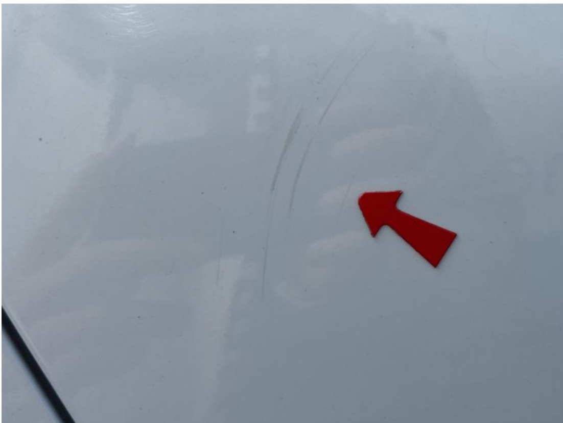
2. Tür hinten rechts - Lackbeschädigung
