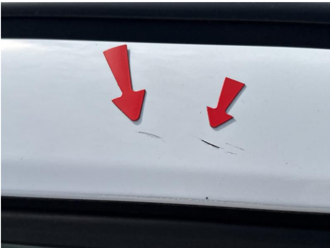
3. Dachholm rechts - Lackbeschädigung
