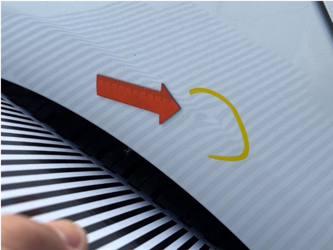
1. Seitenwand hinten rechts - Delle
