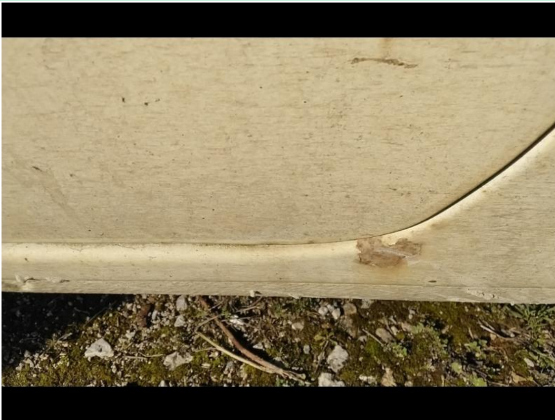
7. Kotflügel 2.Achse rechts hinten - Rostansatz
