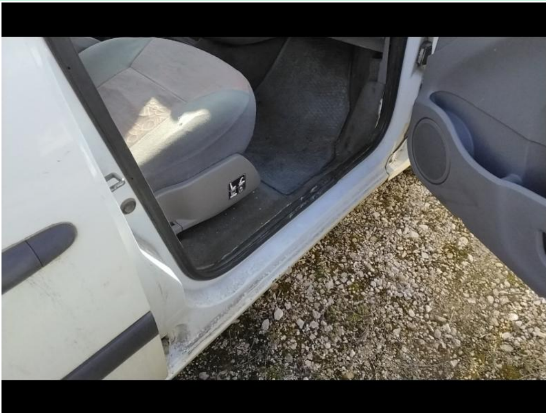
5. Einstiegsleiste vorne links vorne rechts - Lackbeschädigung
