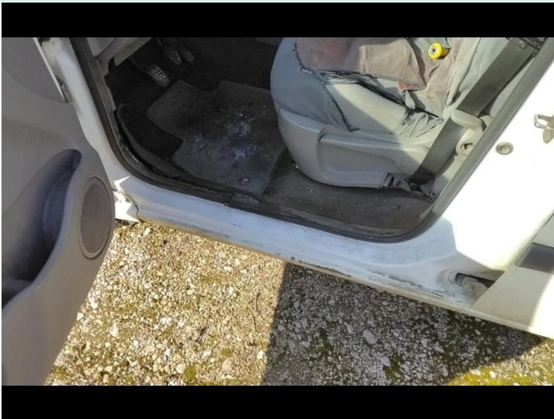
6. Einstiegsleiste vorne links vorne links - Lackbeschädigung
