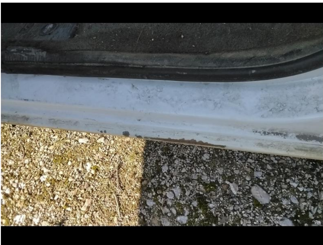
6. Einstiegsleiste vorne links vorne links - Lackbeschädigung
