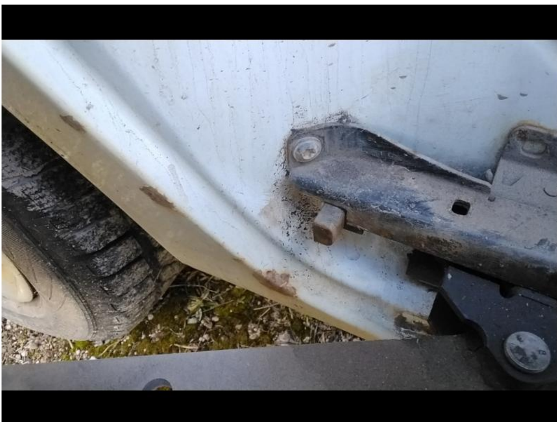
4. Einstiegsleiste vorne links hinten rechts - Lackbeschädigung
