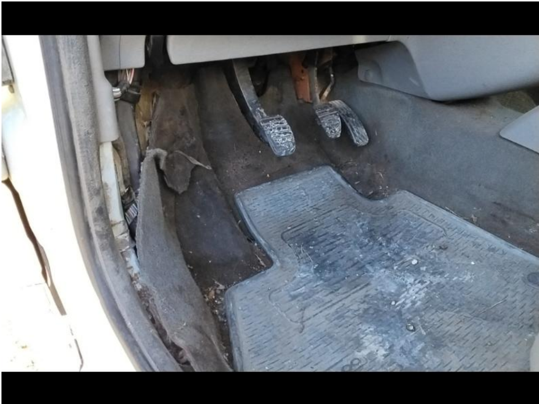
1. Innenverkleidung unten - Beschädigt
