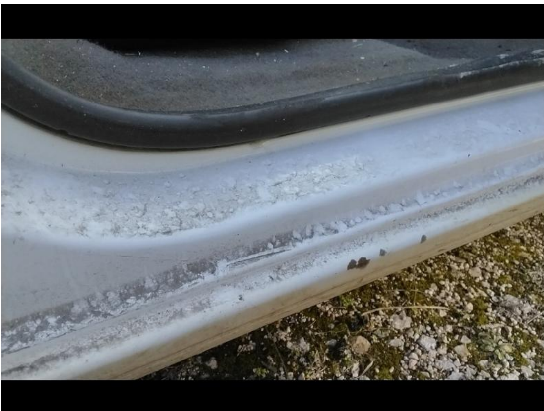
5. Einstiegsleiste vorne links vorne rechts - Lackbeschädigung
