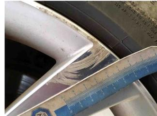
2 - Alufelge glanzgedreht vorne rechts - Kratzer - Ersetzen
