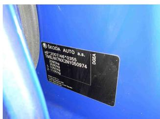
Fahrzeug - Typenschild/Fahrgestellnummer
