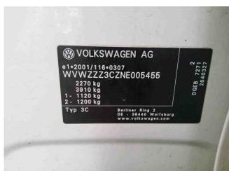
Fahrzeug - Typenschild/Fahrgestellnummer
