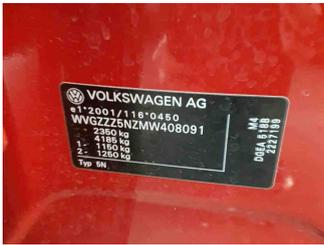
Fahrzeug - Typenschild/Fahrgestellnummer
