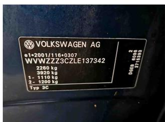
Fahrzeug - Typenschild/Fahrgestellnummer
