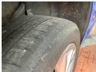
9 - Reifen vorne rechts - Außerhalb Toleranzbereich - Ersetzen
