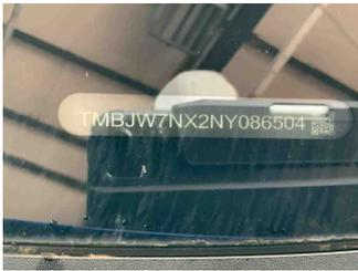
Fahrzeug - Typenschild/Fahrgestellnummer
