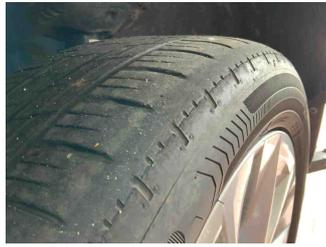
7 - Reifen hinten links - Außerhalb Toleranzbereich - Ersetzen
