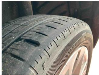
8 - Reifen hinten rechts - Außerhalb Toleranzbereich - Ersetzen
