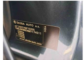
Fahrzeug - Typenschild/Fahrgestellnummer
