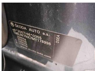
Fahrzeug - Typenschild/Fahrgestellnummer
