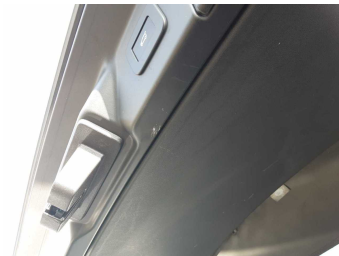
Beschädigung 2: Verkleidungen/Abdeckungen: Heckdeckel, Innenverkleidung - Kratzer - Smart Repair
