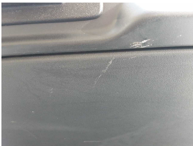
Beschädigung 2: Verkleidungen/Abdeckungen: Heckdeckel, Innenverkleidung - Kratzer - Smart Repair
