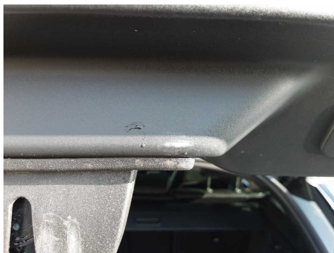
Beschädigung 2: Verkleidungen/Abdeckungen: Heckdeckel, Innenverkleidung - Kratzer - Smart Repair
