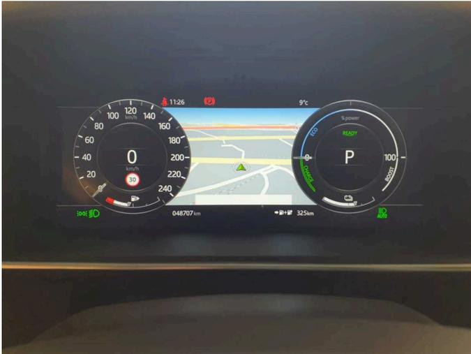
Abbildung 7: Kombiinstrument
