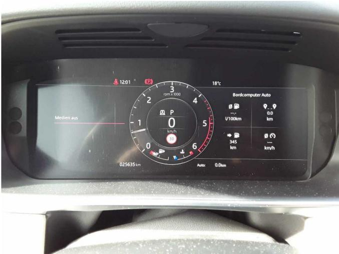
Abbildung 9: Kombiinstrument
