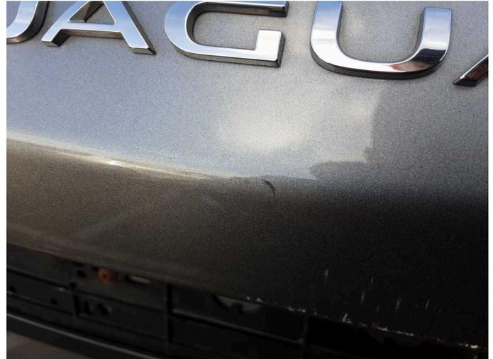
**Beschädigung 4:** Heckklappe/-tür: Heckklappe - Kratzer - Smart Repair
