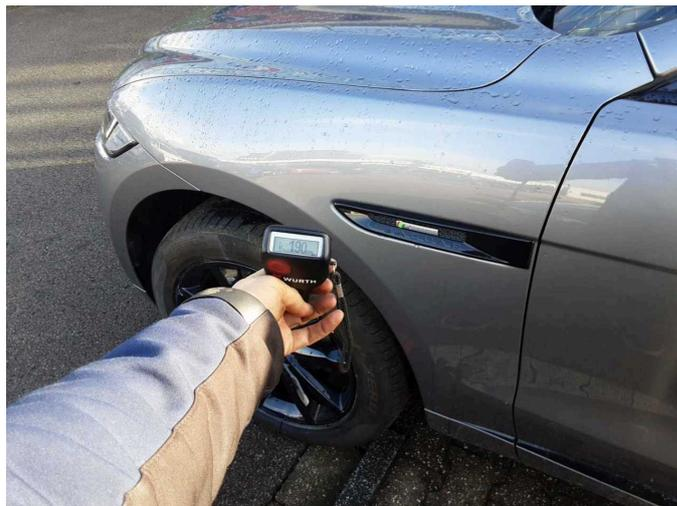
**Kotflügel links:** 190  $\mu\text{m}$
