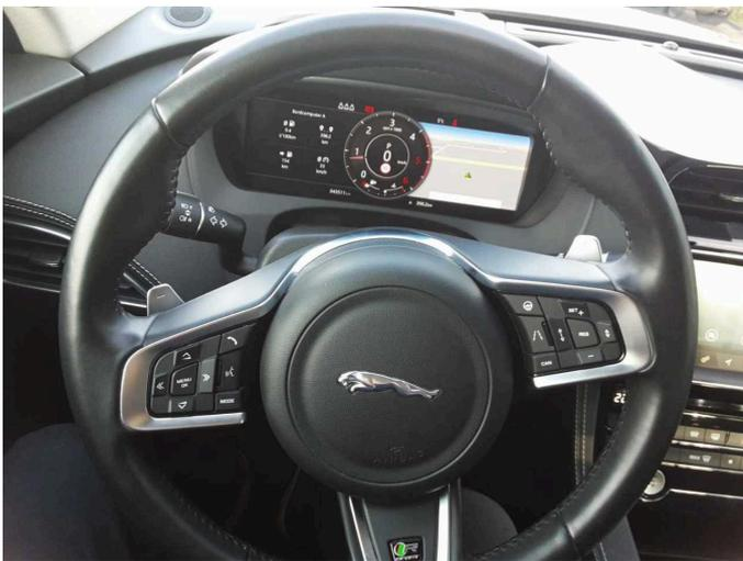
Abbildung 9: Kombiinstrument
