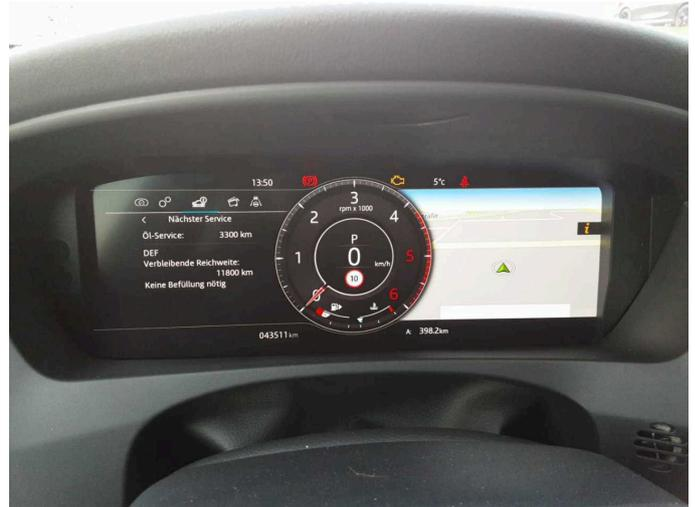
Abbildung 8: Kombiinstrument
