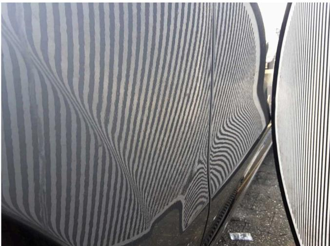
**Beschädigung 5:** Kotflügel links: Kotflügel links (Flecken) - nicht fachgerecht instandgesetzt - instandsetzen und lackieren
