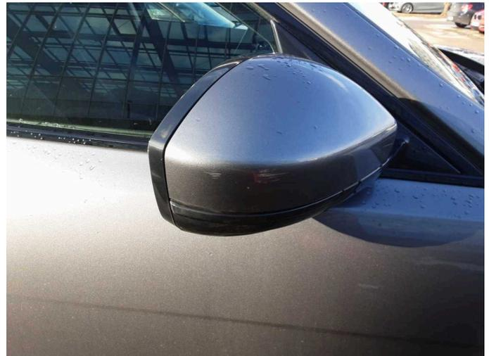
Beschädigung 2: Außenspiegel rechts: Abdeckkappe - Kratzer - Smart Repair
